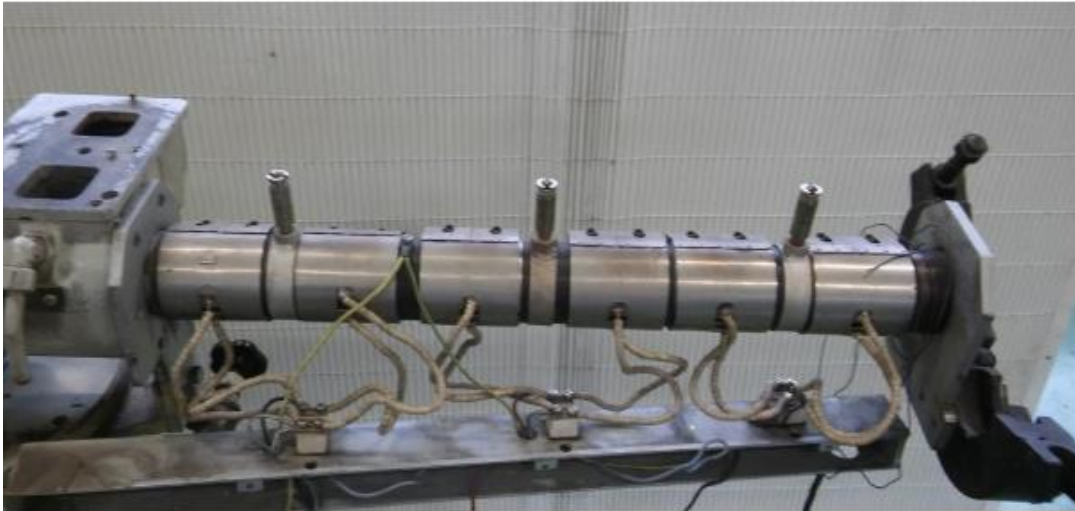
Slika 15. Unutarnji grijači podijeljeni u tri toplinske zone [1]
