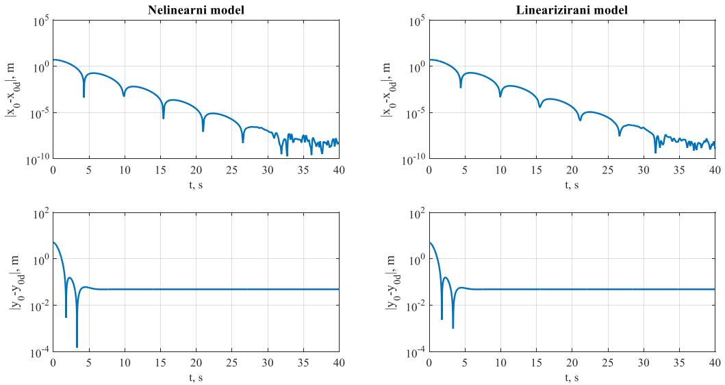
**Slika 53.** Usporedba absolutnih pogreški pozicije tereta nelinearnog i lineariziranog modela kod LQR bez uklanjanja poremećaja
