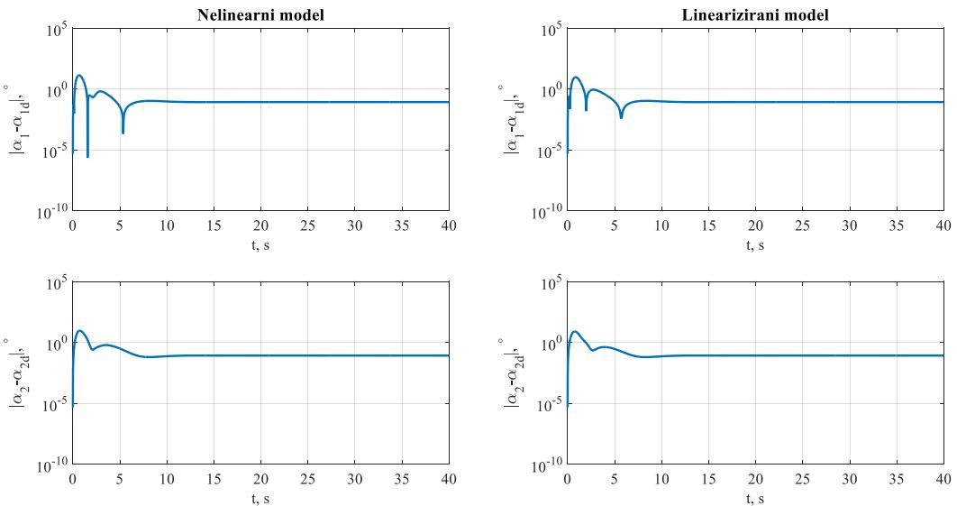
**Slika 55.** Usporedba absolutnih pogreški kutova između tereta i dviju letjelica nelinearnog i lineariziranog modela kod LQR bez uklanjanja poremećaja
