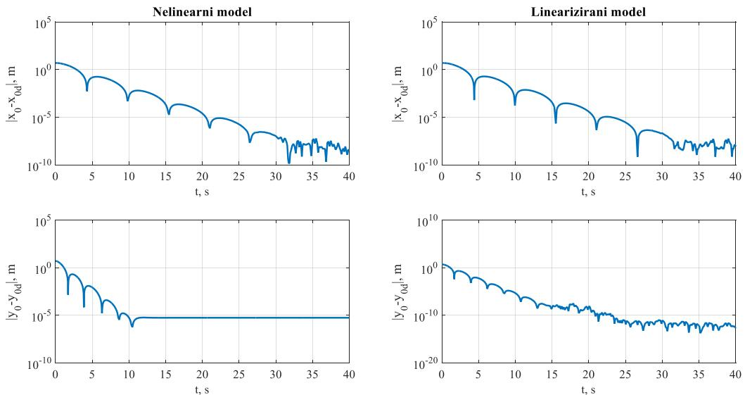
**Slika 60. Usporedba absolutnih pogreški pozicije tereta nelinearnog i lineariziranog modela kod LQR uz uklanjanje poremećaja**
