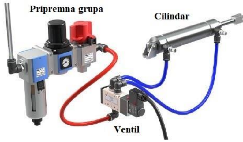
Slika 22. Osnovne komponente pneumatskog sustava
