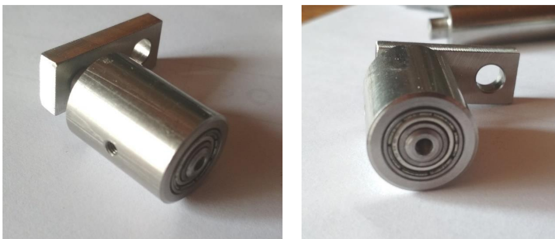
Slika 11. Dio uške za spoj s cilindrom
