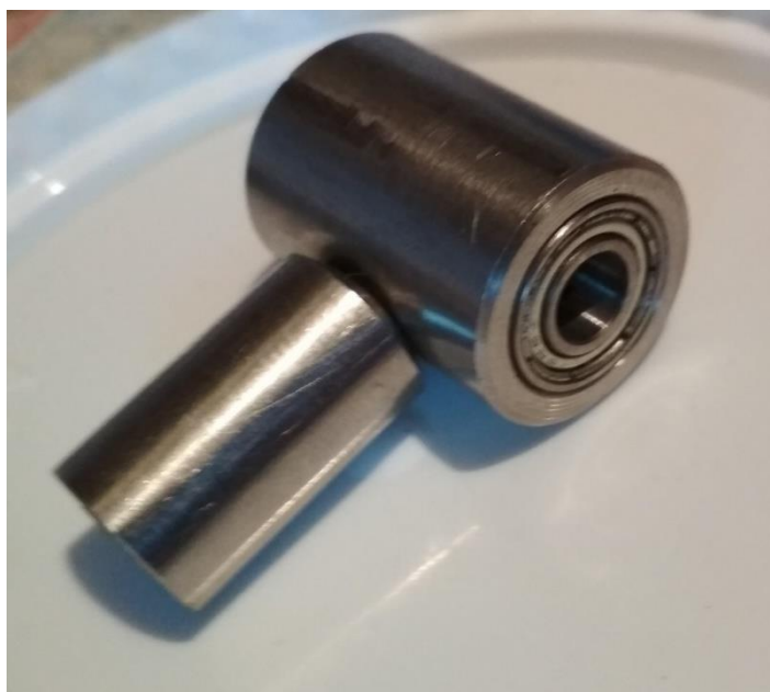
Slika 13. Spoj oba dijela – uška
