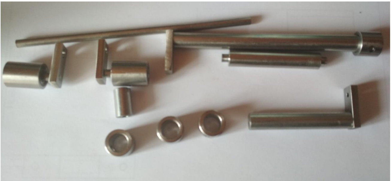
Slika 2. Dijelovi koljenastog vratila
