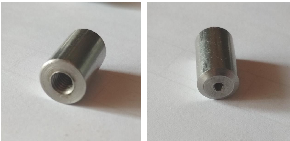
Slika 11. Dio uške za spoj s cilindrom
