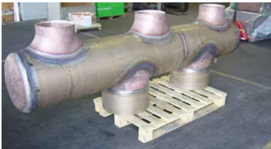
Slika 7. Zavarena konstrukcija izrađena od Cu – Ni legure [10]
