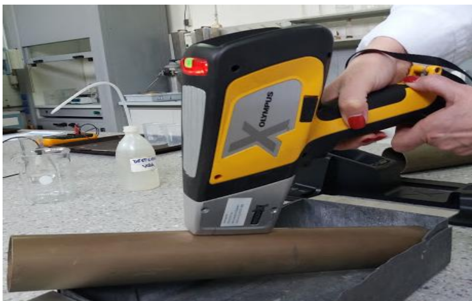
Slika 28. Ispitivanje kemijskog sastava uređajem Olympus XRF
