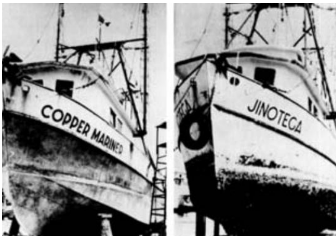
Slika 22. Usporedba obraštanja trupova broda izrađenih od 90/10 Cu – Ni legure te čelika [2]
