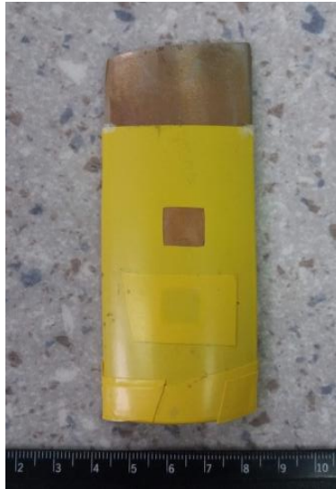
Slika 29. Uzorak pripremljen za elektrokemijsko ispitivanje
