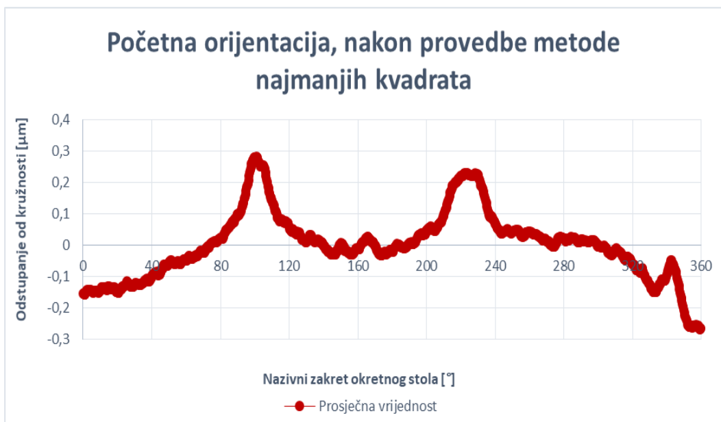
Slika 92. Odstupanje od kružnosti - početna orijentacija, prosječna vrijednost
