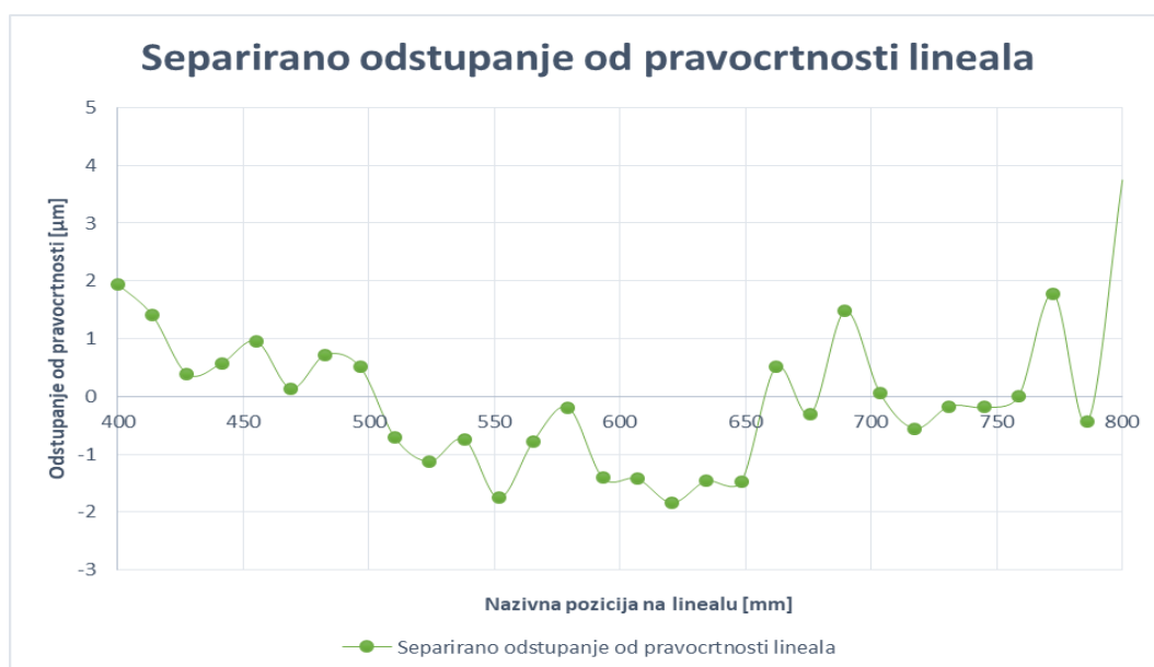
Slika 67. Separirano odstupanje od pravocrtnosti lineala 400-800 mm
