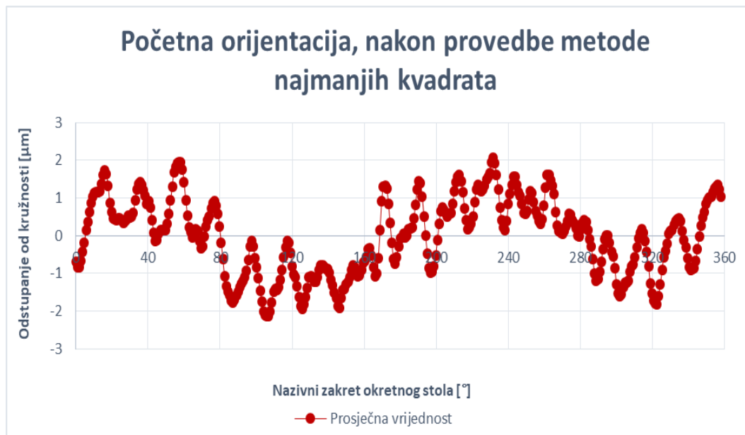
Slika 84. Odstupanje od kružnosti - početna orijentacija, prosječna vrijednost
