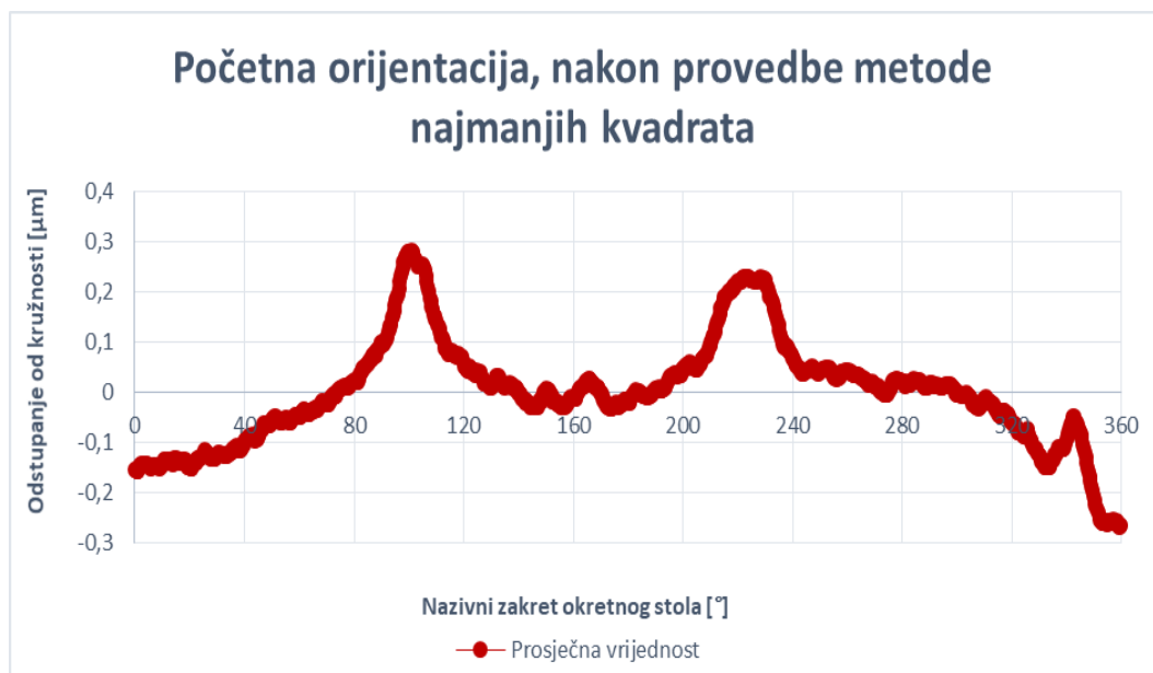
Slika 92. Odstupanje od kružnosti - početna orijentacija, prosječna vrijednost
