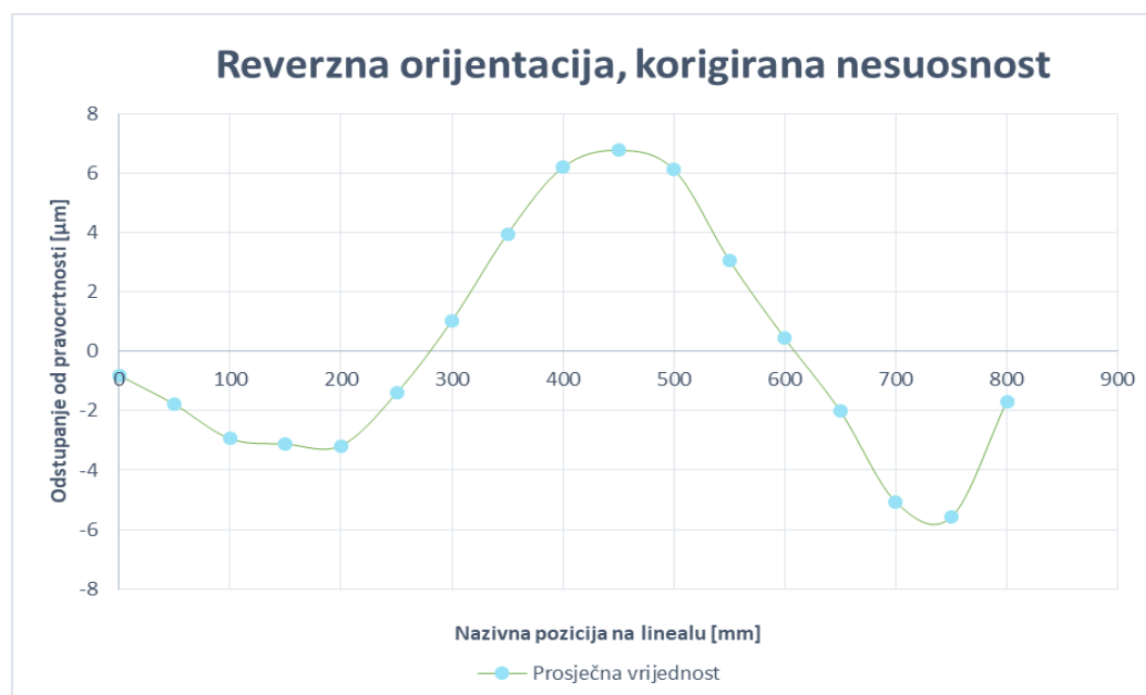
Slika 48. Odstupanje od pravocrtnosti - reverzna orijentacija, korigirana nesuosnost, prosječna vrijednost
