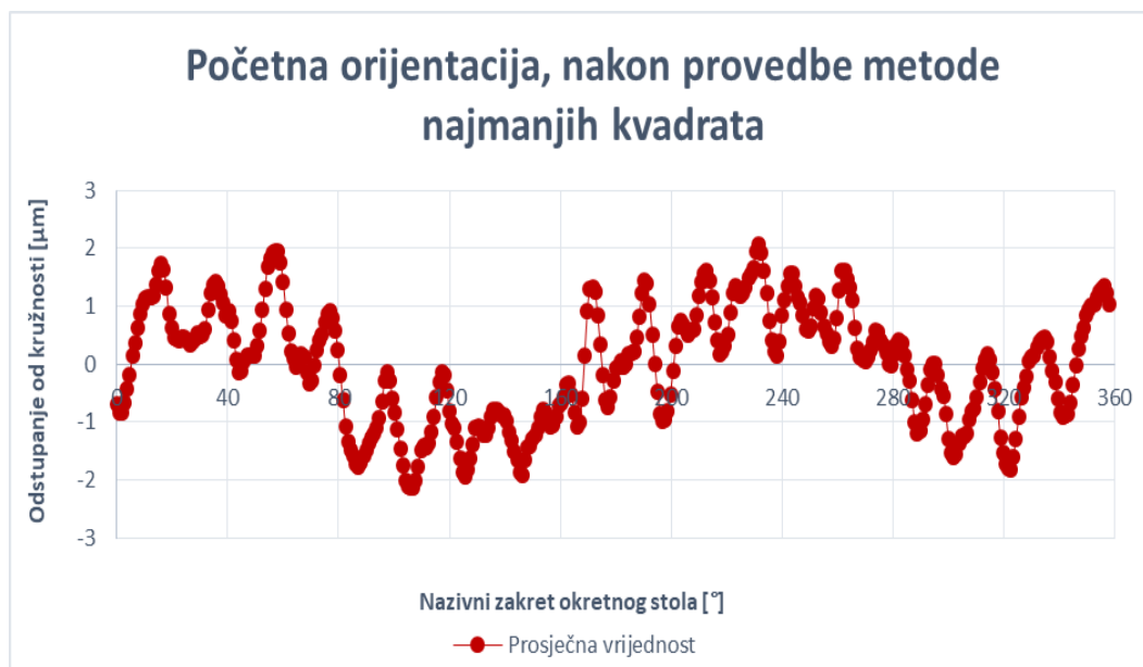
Slika 84. Odstupanje od kružnosti - početna orijentacija, prosječna vrijednost
