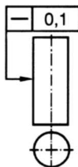
Slika 10. Primjer tolerancije pravocrtnosti [8]
