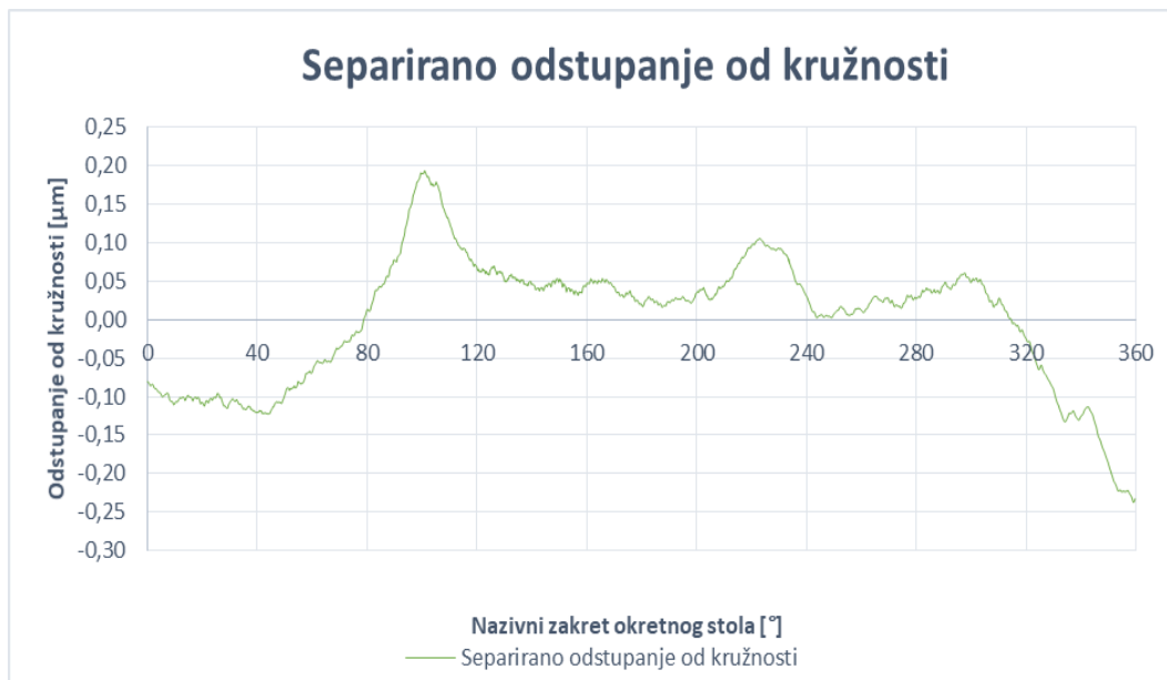
Slika 96. Separirano odstupanje od kružnosti
