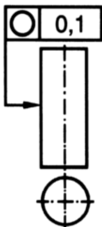
Slika 12. Primjer tolerancije kružnosti [10]
