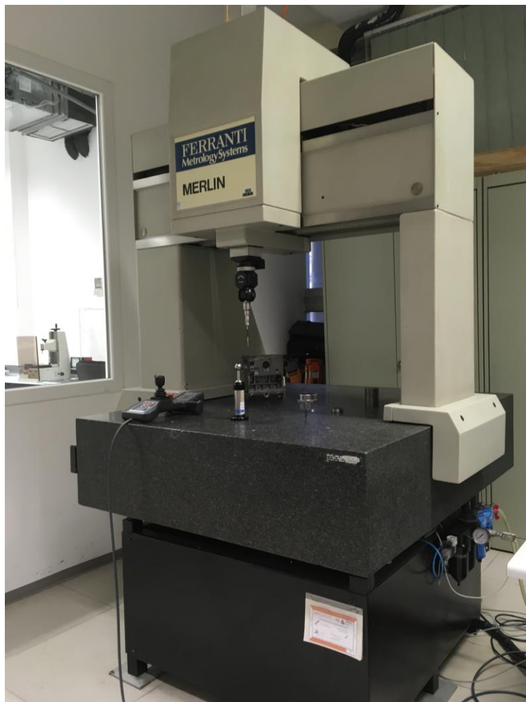
Slika 22. Trokordinatni mjerni uređaj
