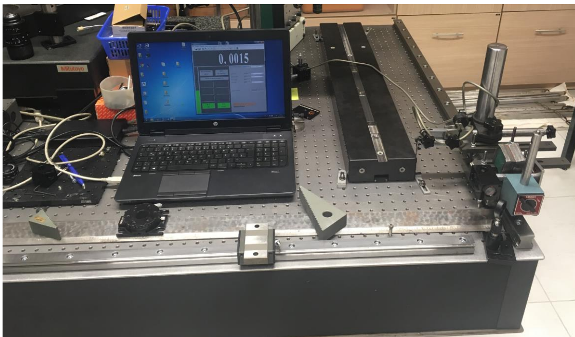
Slika 56. Primjer ishodišne točke laserskog interferometra
