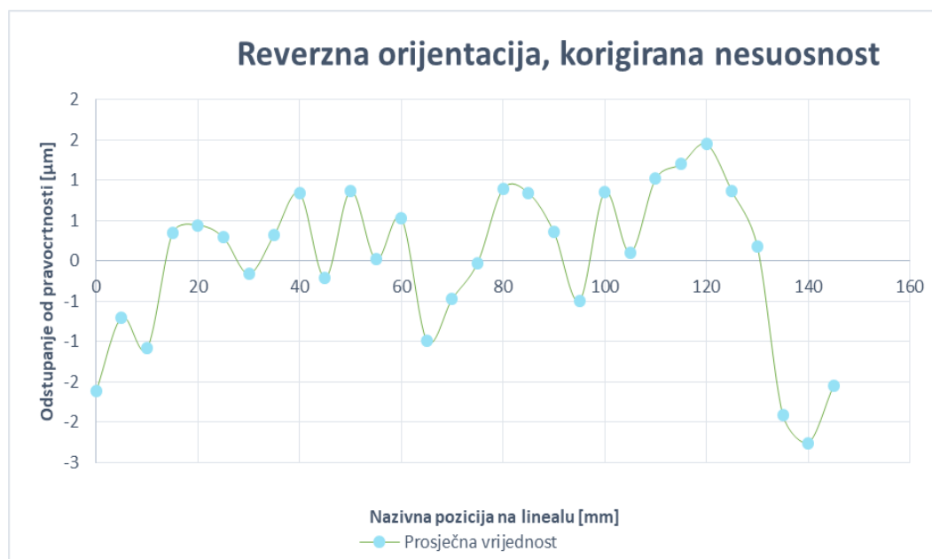
Slika 77. Odstupanje od pravocrtosti - reverzna orijentacija, korigirana nesuosnost prosječna vrijednost
