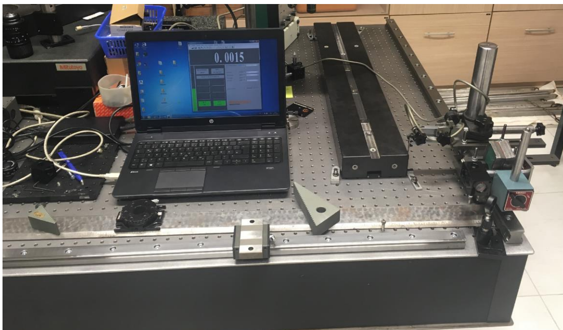
Slika 56. Primjer ishodišne točke laserskog interferometra
