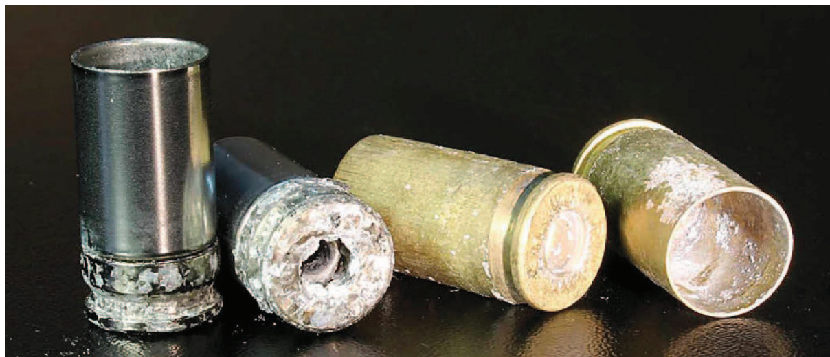
Slika 17. Nehrđajući dio koji nije korodirao [15].
