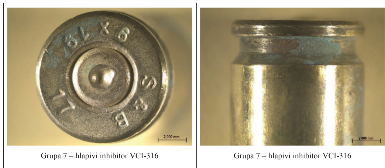
Tablica 22. Prikaz površine uzoraka iz slane komore nakon čišćenja korozivskih produkata (nastavak).
