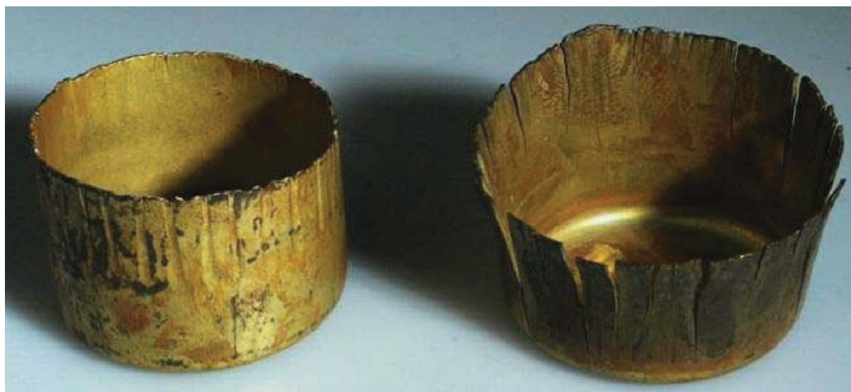
Slika 15. Napetosna korozija čahura strjeljiva nastala u agresivnom okruženju amonijaka [11].
