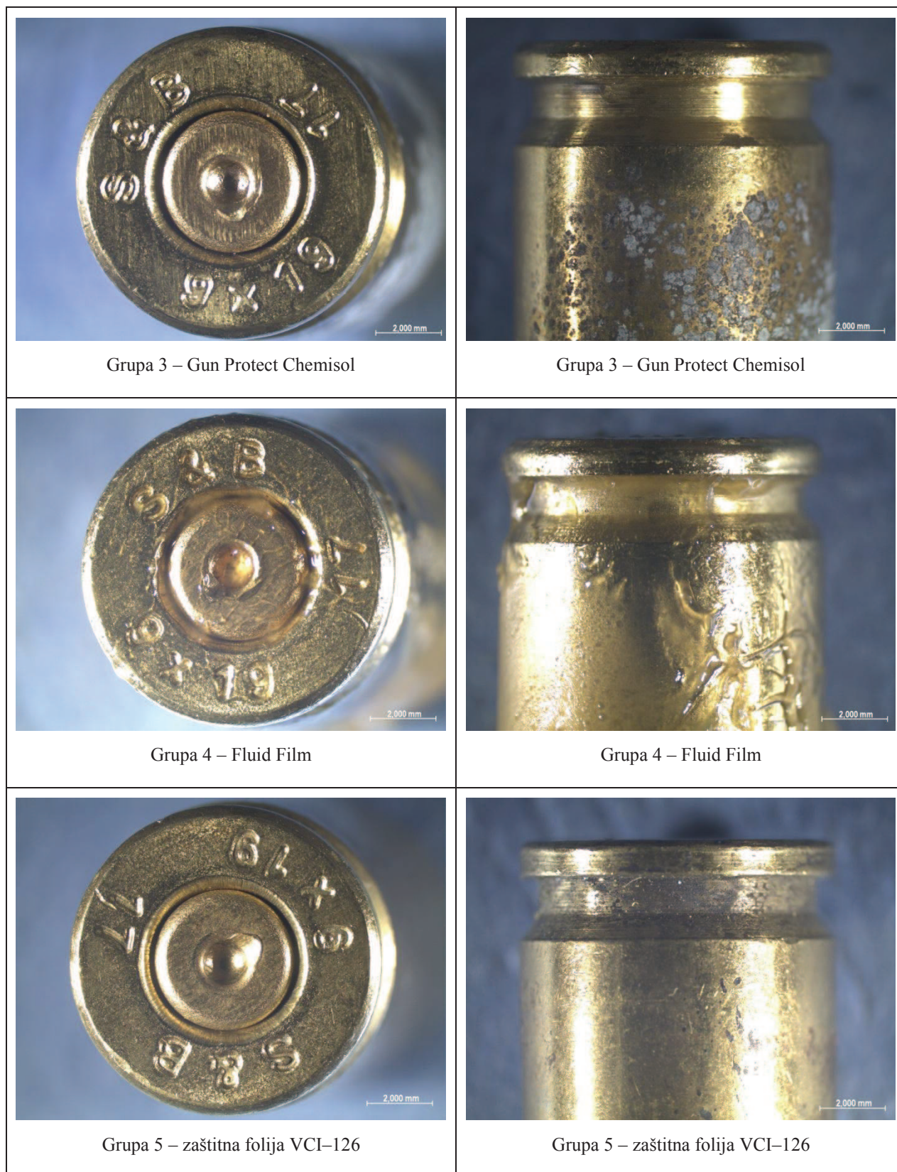
Tablica 13. Prikaz površine uzoraka nakon provedenih ispitivanja u vlažnoj komori (nastavak).
