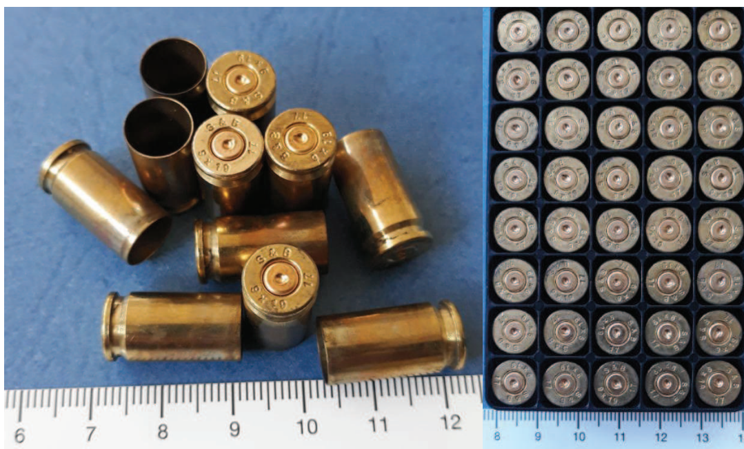
Slika 22. Ispitni uzorci mjedenih čahura kalibra 9 x 19 mm „Parabellum“.
