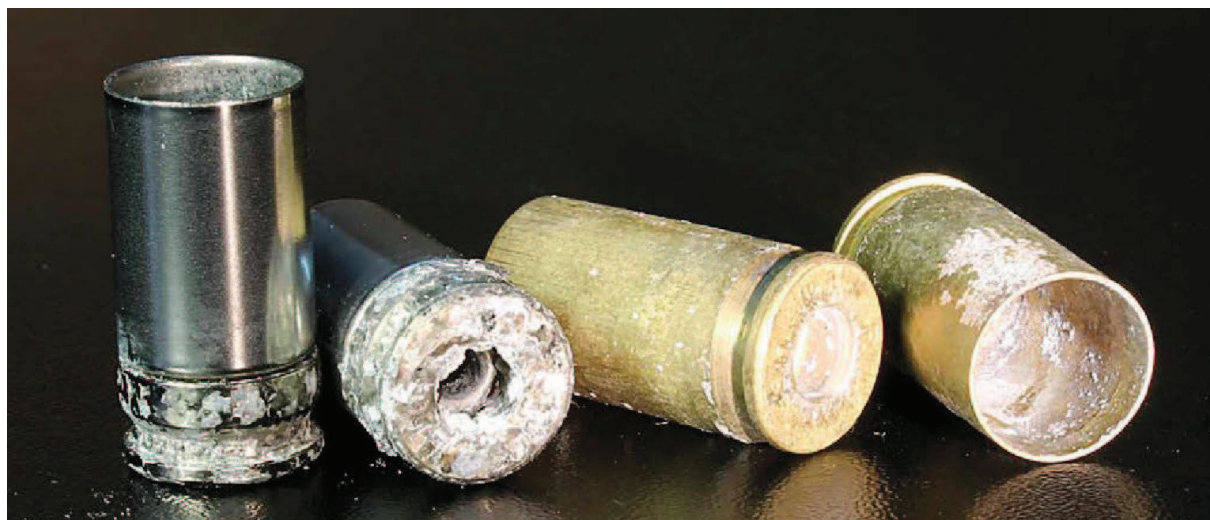
Slika 17. Nehrđajući dio koji nije korodirao [15].
