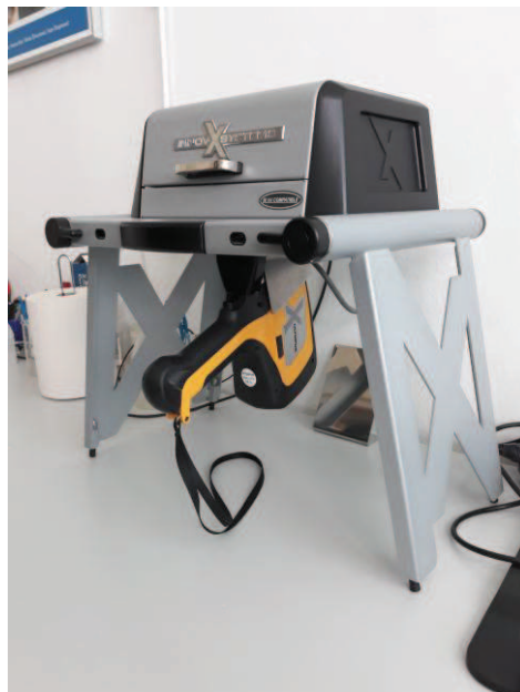
Slika 23. Prijenosni uređaj za rentgensku fluorescentnu spektrometrijsku analizu (XRF).
