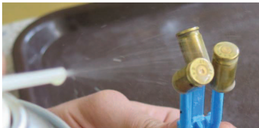
Slika 27. Nanošenje hlapivog inhibitora korozije Cortec VCI-369.
