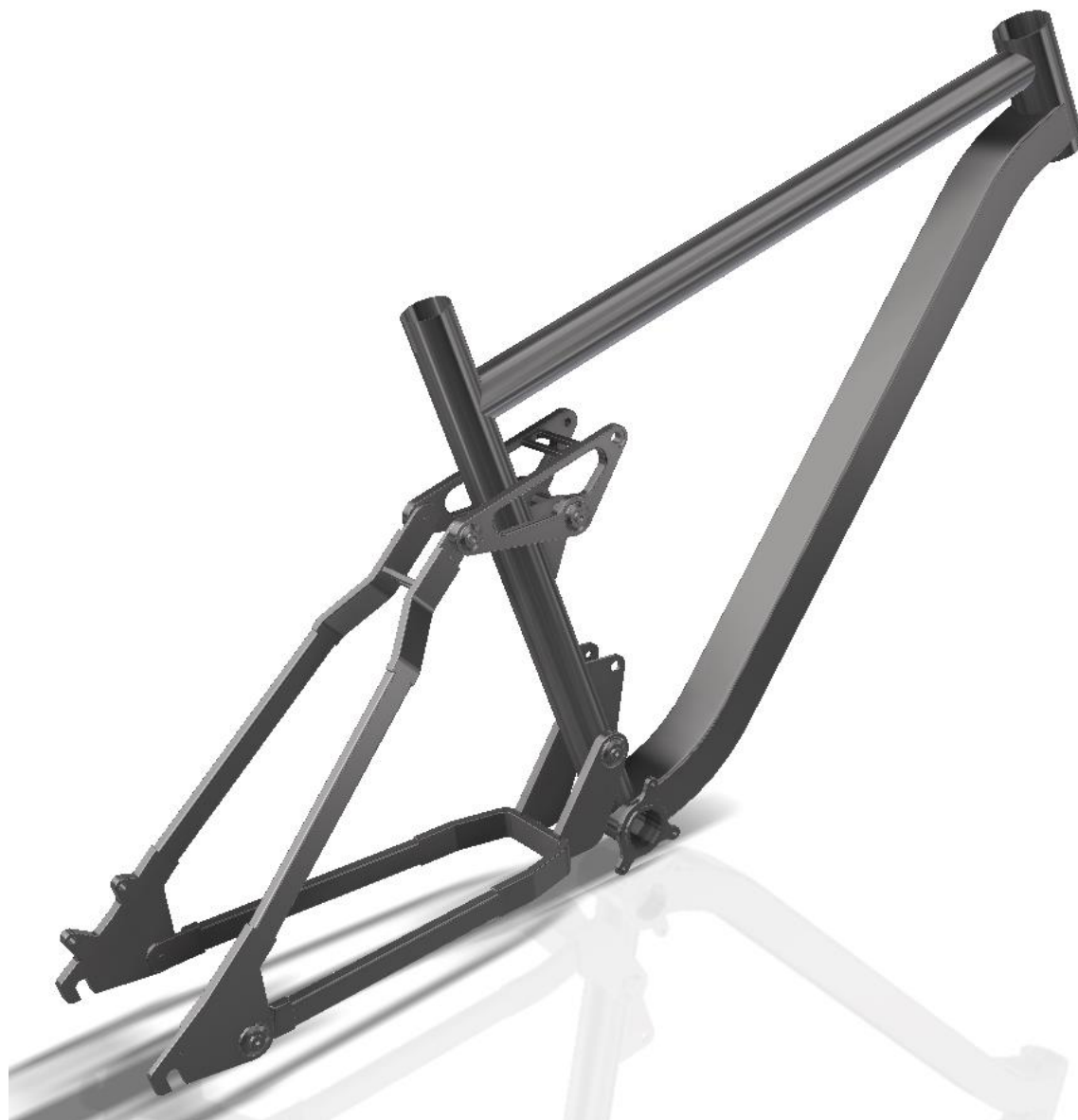
Slika 6.7. Model konstrukcije okvira
