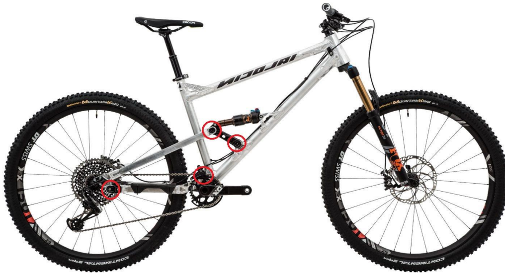
Slika 3.2. Zglobovi Horst-link ovjesa [14]
