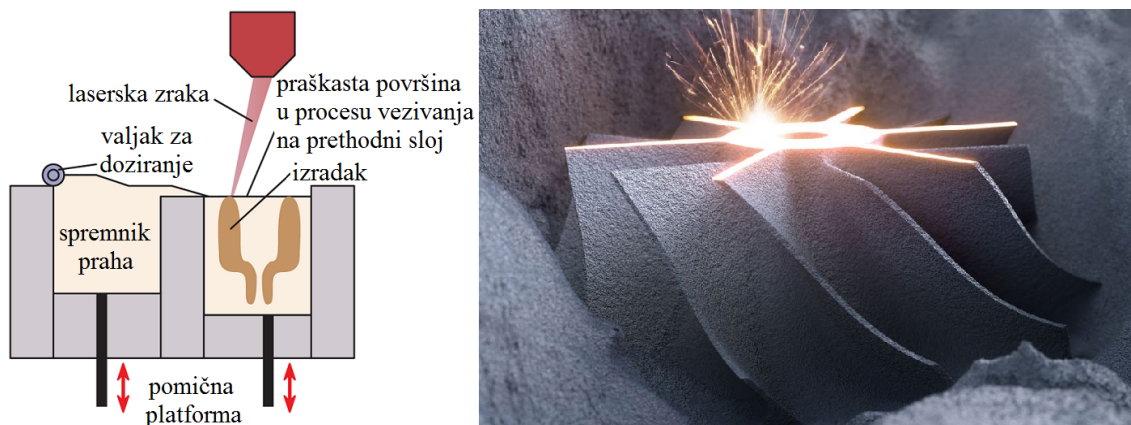
Slika 58. Shematski prikaz selektivnog laserskog srašćivanja popraćen primjerom
