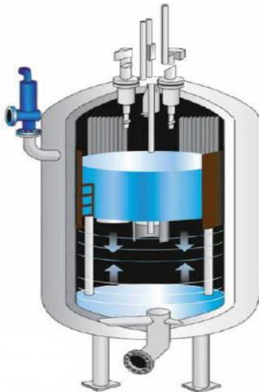
Slika 11. Električni vrelvodni kotao- regulacija promjenom razine vode [10]
