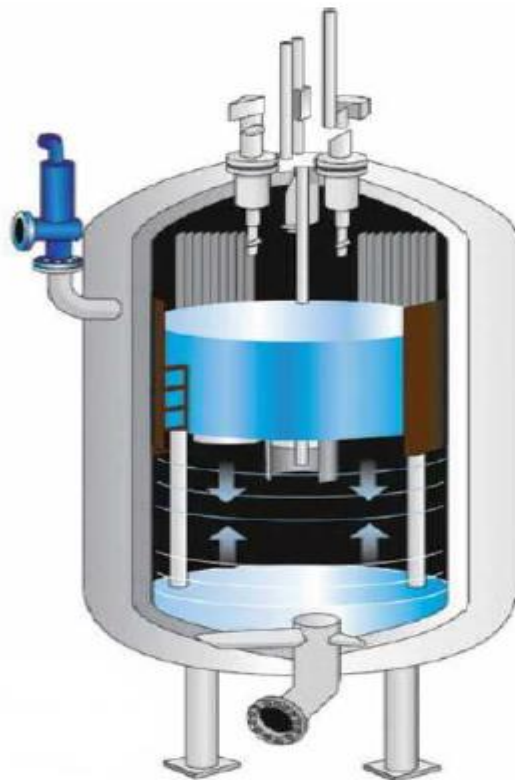
Slika 11. Električni vrelvodni kotao- regulacija promjenom razine vode [10]
