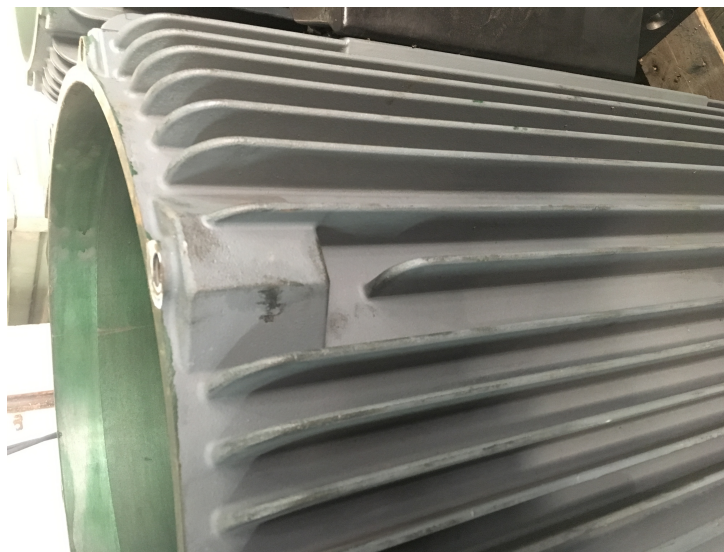
Slika 57. Stvarni model kućišta sa zaobljenim rebrima te jednim skraćenim rebrom [17]
