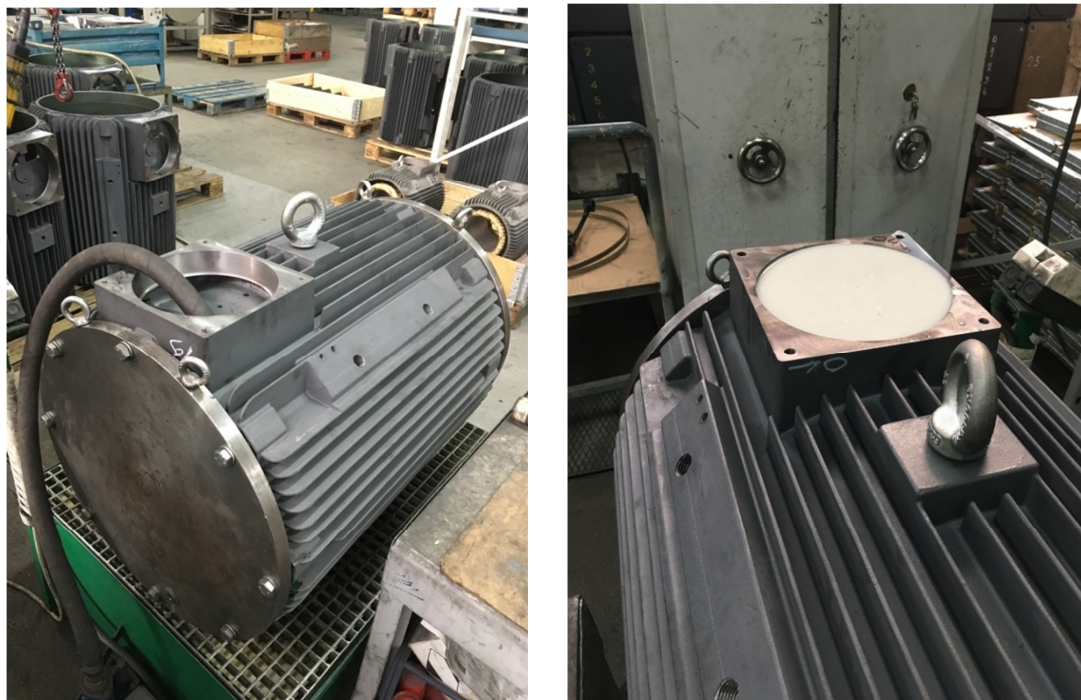
Slika 42. Punjenje kućišta uljnom emulzijom [17]
