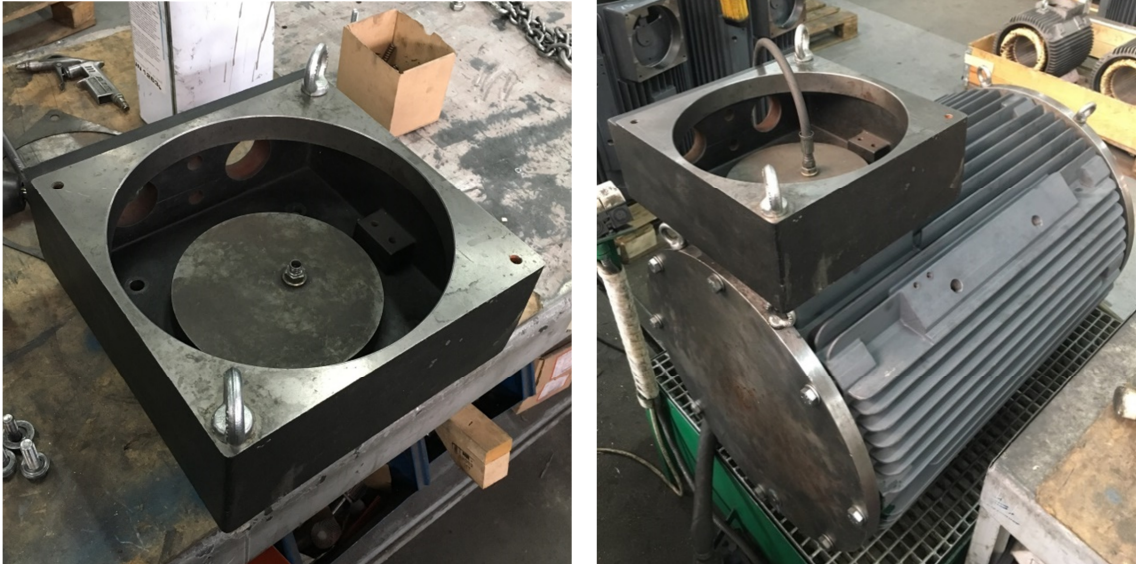
Slika 43. Kutija za zatvaranje gornjeg otvora na kućištu, spajanje crijeva pumpe [17]
