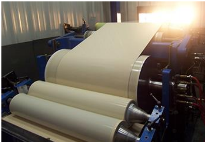
Slika 16 IC sušenje "coil coatinga" [32]
