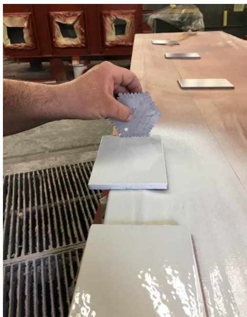
Slika 36 Mjerenje debljine mokrog filma
