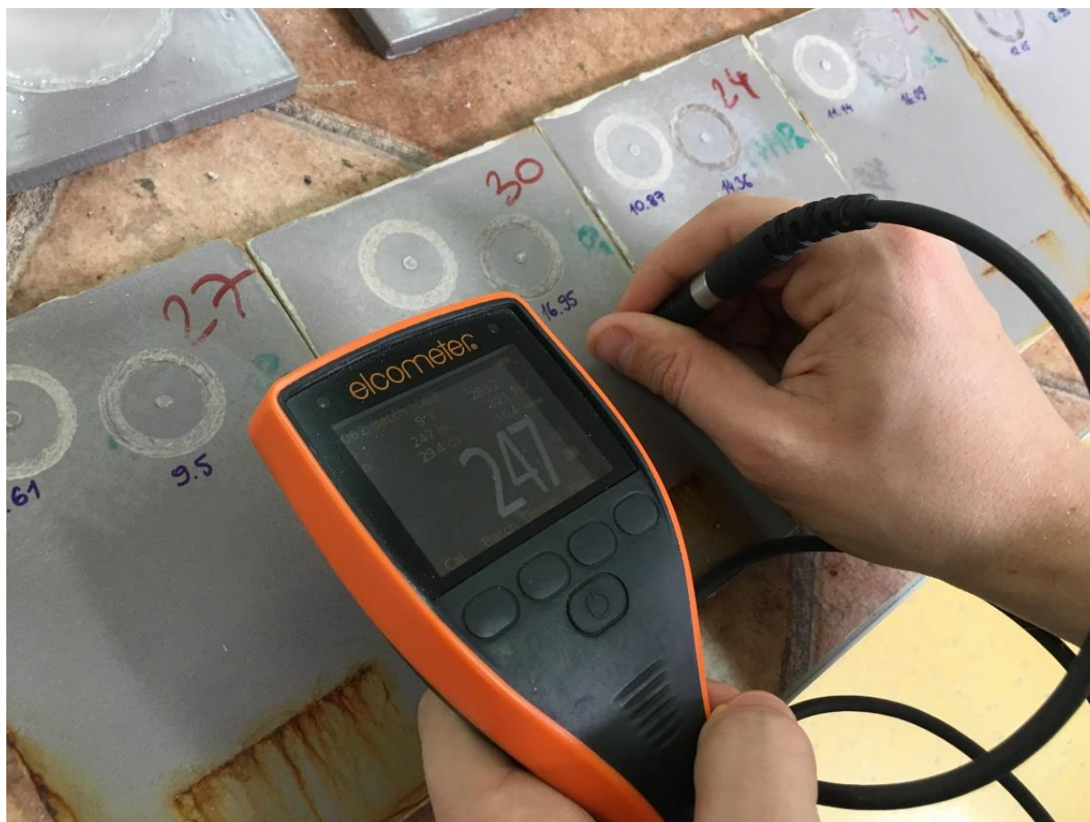
Slika 37 Mjerenje debljine suhog filma premaza uređajem Elcometer 456
