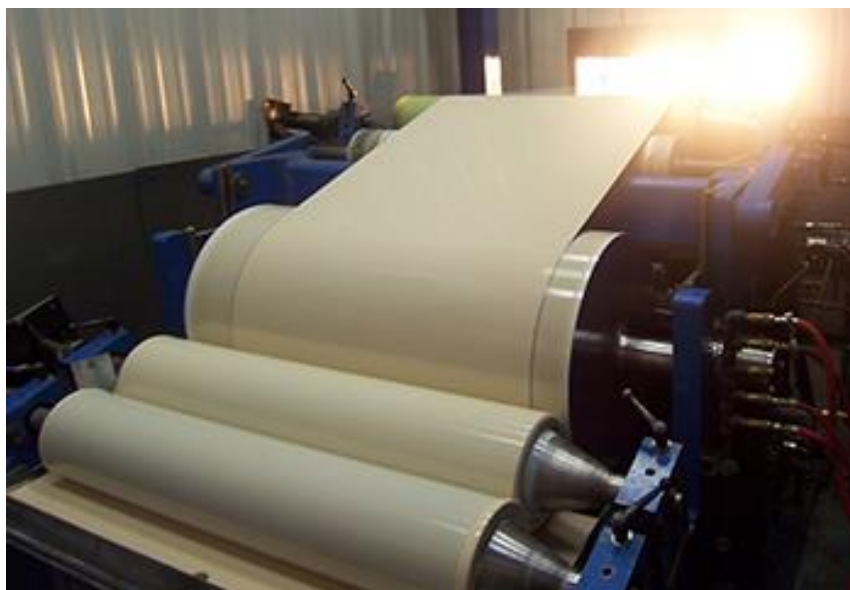
Slika 16 IC sušenje "coil coatinga" [32]
