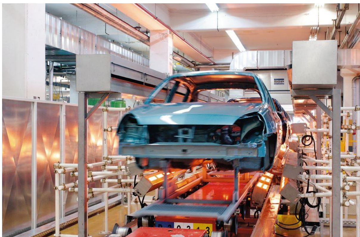
Slika 19 IC sušenje automobila [35]
