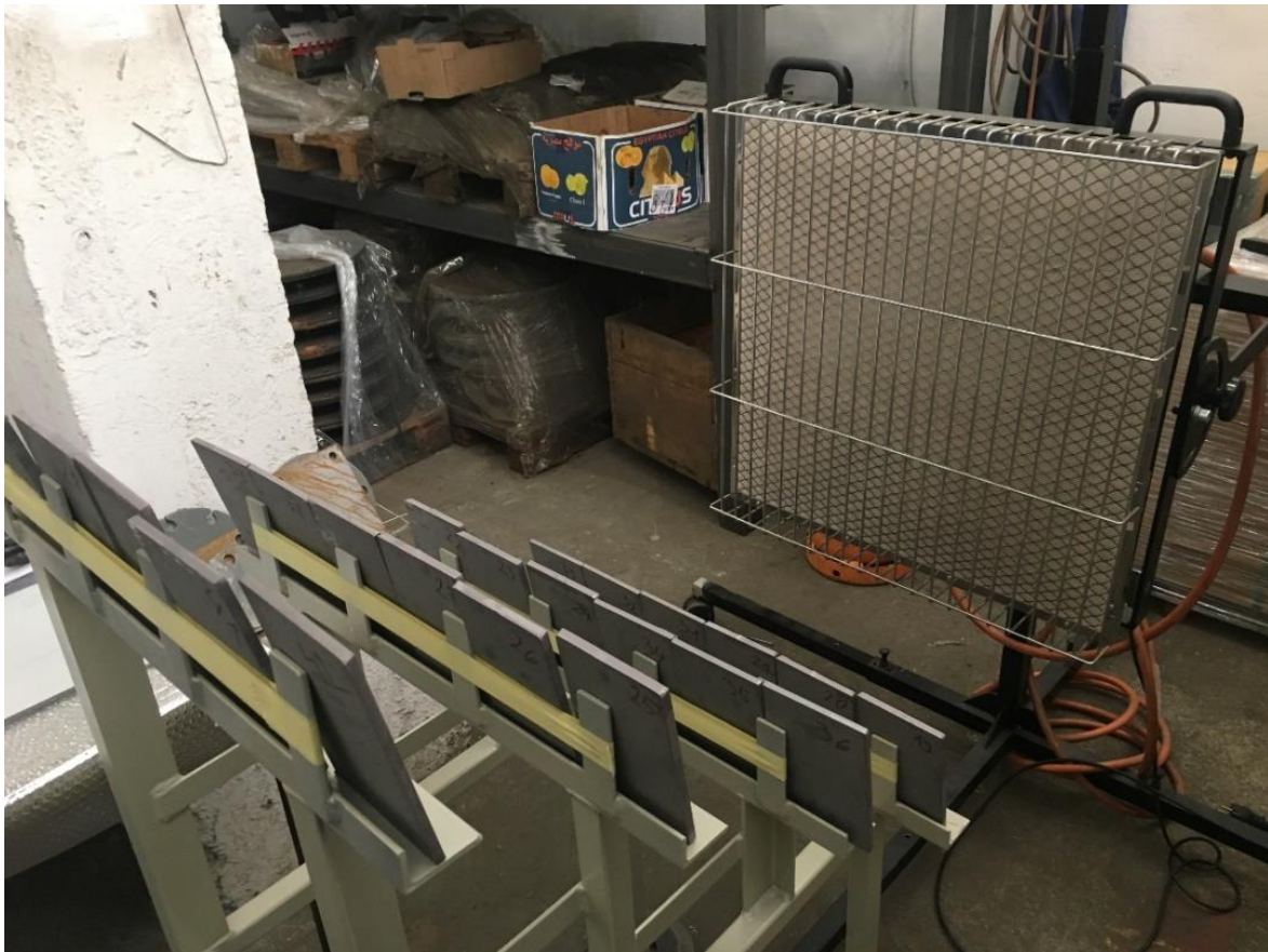
Slika 13 Plinski IC emiter korišten za provedbu eksperimentalnog dijela rada sa ispitivanim uzorcima, Končar MK
