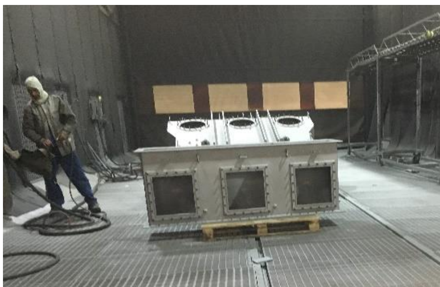
Slika 29 Kabina za pjeskarenje te uzorak za pjeskarenje, Končar MK
