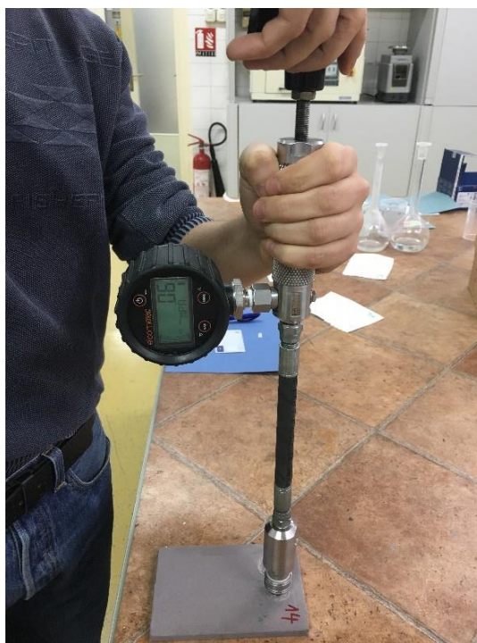
Slika 44 Pull-off metoda za ispitivanje prionjivosti, Laboratorij za zaštitu materijala, FSB
