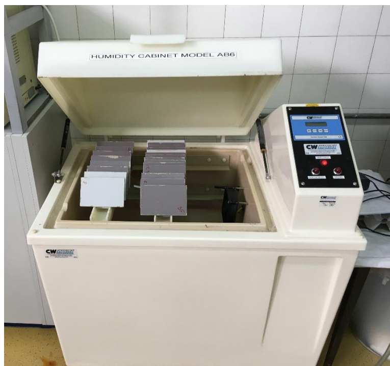
Slika 42 Uzorci u vlažnoj komori, Laboratorij za zaštitu materijala, FSB
