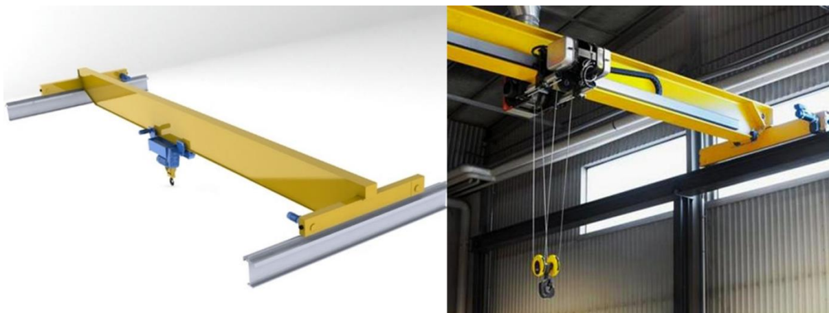
Slika 3. Mosni granici s jednim glavnim nosačem (jednogredni) [6],[5]
