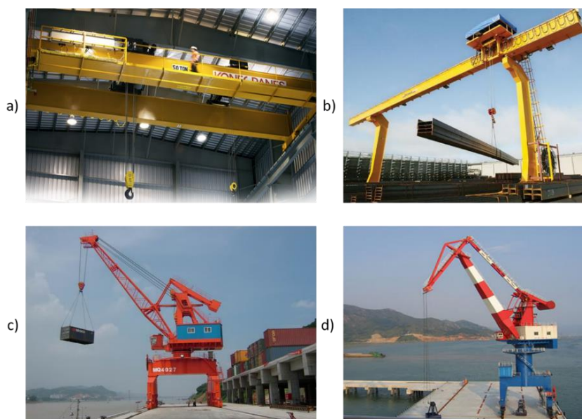
Slika 1. a) Mosni granik [1], b) portalni granik [2], c) dohvatni jednokraki granik [3] i d) dohvatni dvokraki granik [4]
