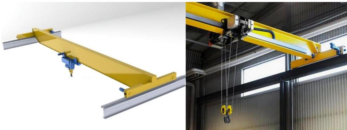
**Slika 3. Mosni granici s jednim glavnim nosačem (jednogredni) [6],[5]**
