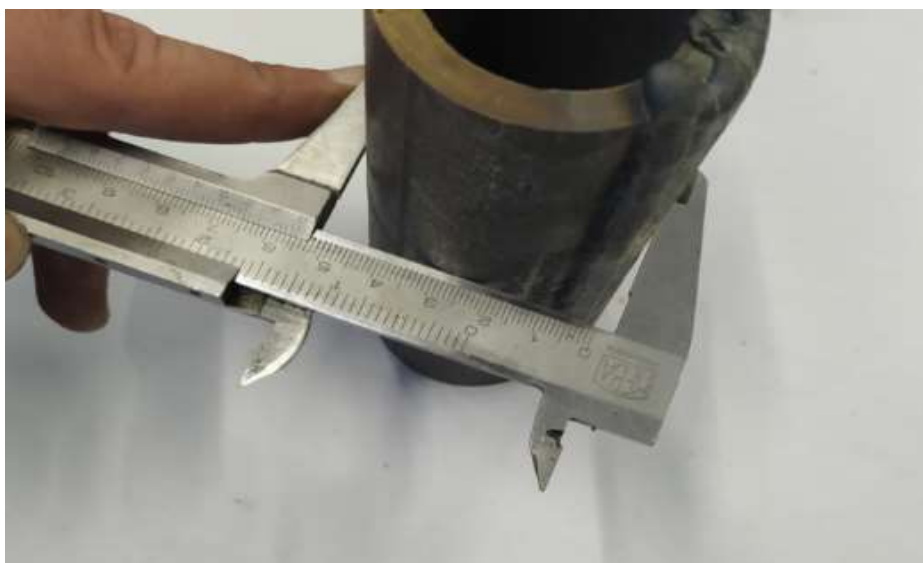
Slika 35. Indirektno mjerenje visine navarenog sloja
