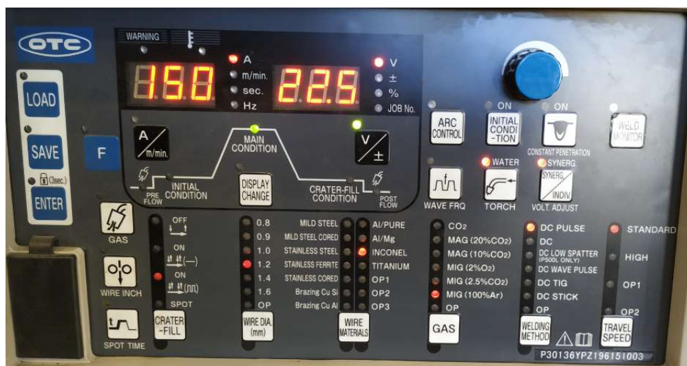
Slika 31. Upravljačko sučelje izvora struje za zavarivanje s postavljenim osnovnim parametrima
