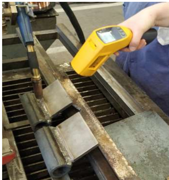
Slika 40. Provjera međuprolazne temperature Fluke 568 IR termometrom
