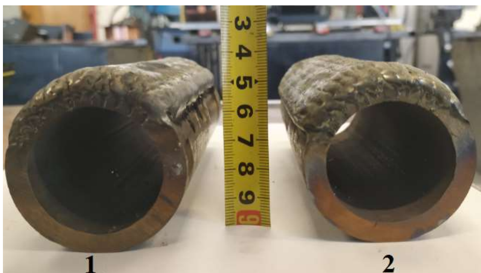
Slika 34. Izgled uzoraka nakon navarivanja – pogled s bočne strane
