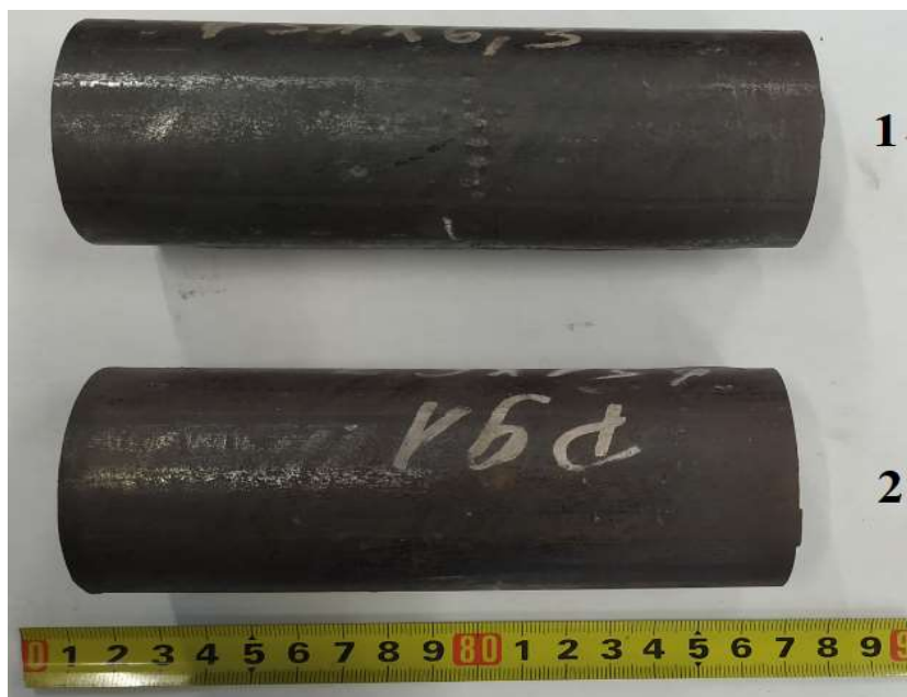
Slika 26. Izgled uzoraka prije navarivanja Inconel legure
