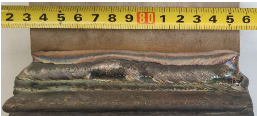
Slika 44. Uzorak 2 – prva strana; automatizirani MIG, neutralna tehnika
