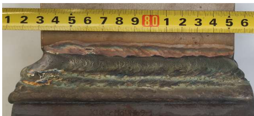
Slika 43. Uzorak 1 – druga strana; ručni MIG, tehnika njihanja
