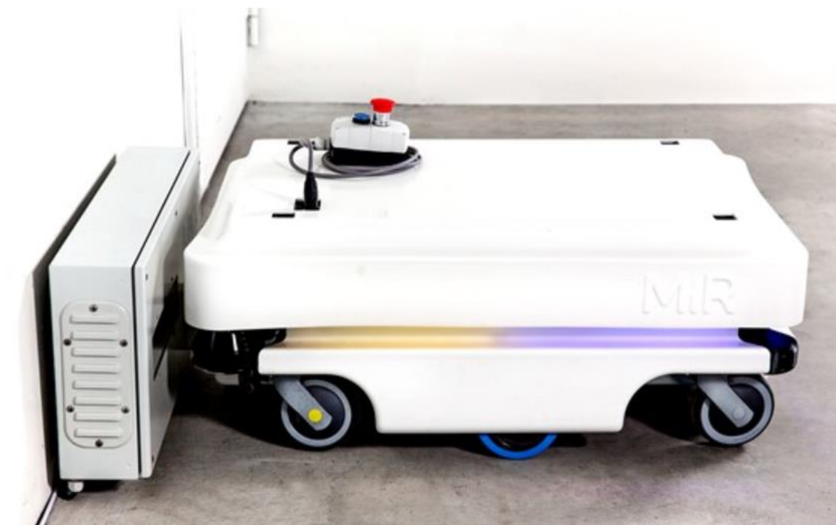
Slika 22. Punjenje roobota na MiR stanici za punjenje[4]
