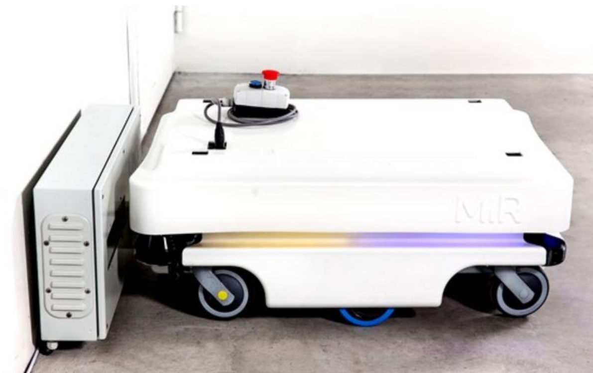
Slika 22. Punjenje roobota na MiR stanici za punjenje[4]
