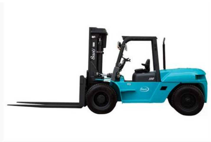
Slika 12. Baoli viličar pogonjen motorom s unutarnjim izgaranjem[3]
