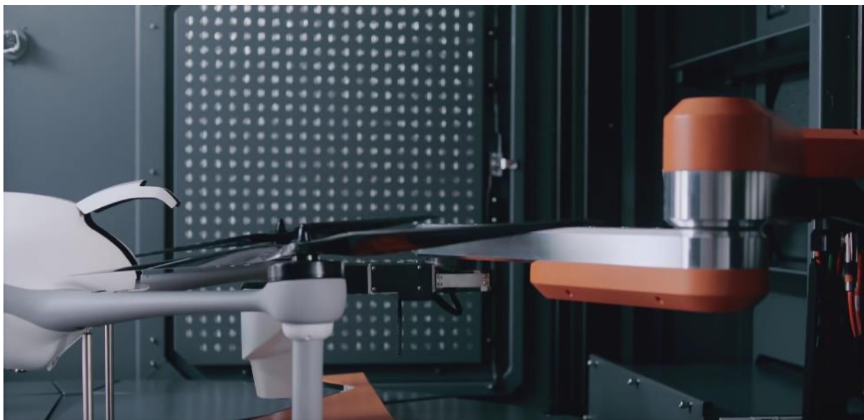
Slika 28. Prikaz vađenja baterije iz drona pomoću manipulatora[7]
