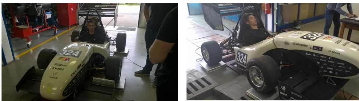
Slika 29. Mjerenje težišta bolida Strix s vozačem na horizontalnoj podlozi (lijevo) te na kosini (desno)
