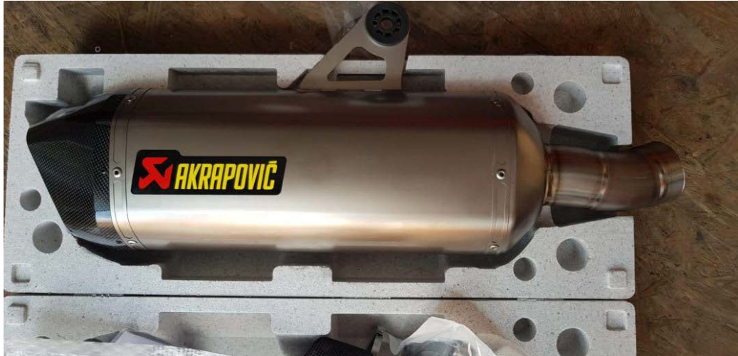
Slika 31. Lonac za prigušivanje zvuka Akrapovič BMW R 1200 GS [8]
