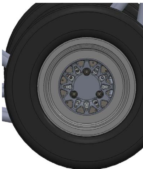
Slika 27. Srce kotača bolida Strix
