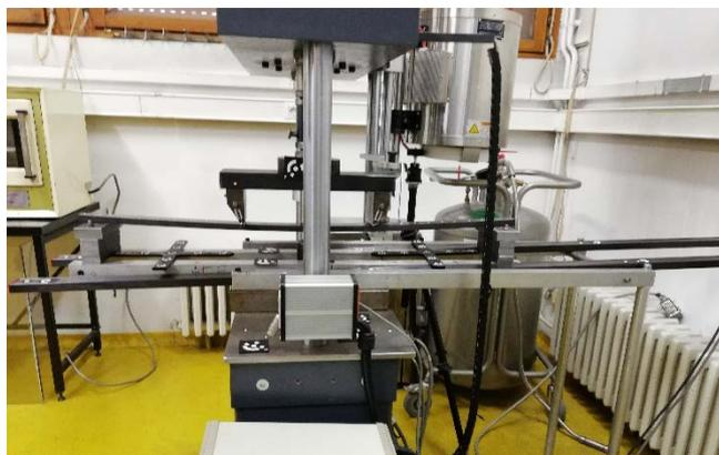
Slika 36. Testiranje lisnate opruge opterećivanjem opruge u sredini
