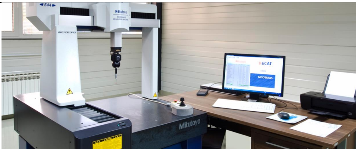
Slika 6. Trokoordinatni mjerni uređaj Mitutoyo S544 [1]
