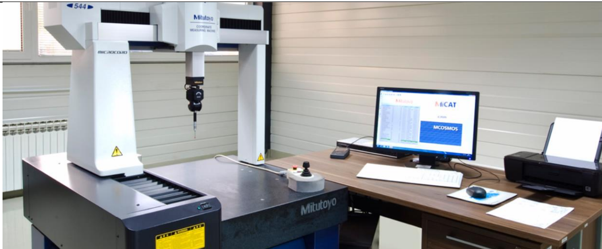
Slika 6. Trokoordinatni mjerni uređaj Mitutoyo S544 [1]
