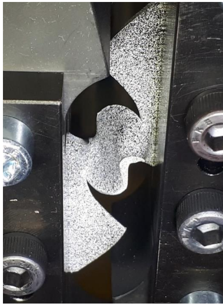
Slika 6.10. Deformirani ispitni uzorak debljine 2 mm
