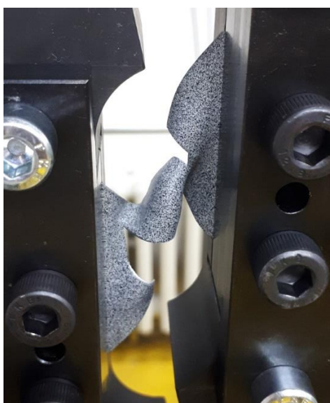
Slika 6.6. Deformirani ispitni uzorak debljine 1 mm
