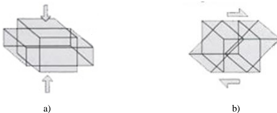
Slika 2.4. Primjer: a) čistog i b) jednostavnog smika [6]
