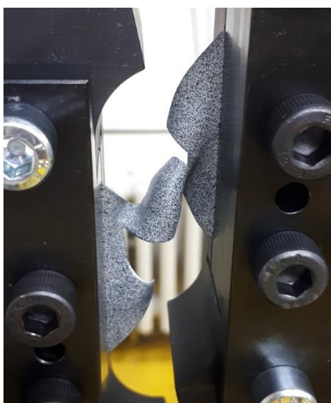
Slika 6.6. Deformirani ispitni uzorak debljine 1 mm
