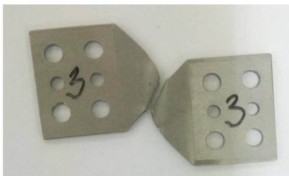
Slika 6.14. Deformirani uspitni uzorak debljine 3 mm [16]
