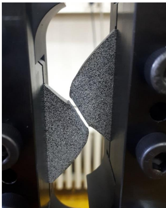
Slika 6.18. Deformirani ispitni uzorak debljine 4 mm
