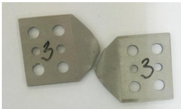
Slika 6.14. Deformirani uspitni uzorak debljine 3 mm [16]
