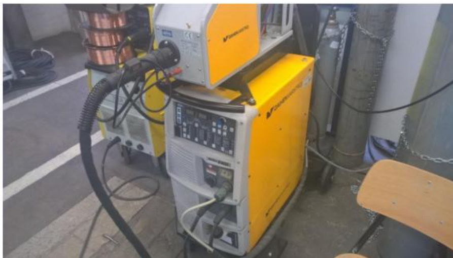
Slika 17. Izvor struje za impulsno MIG zavarivanje
