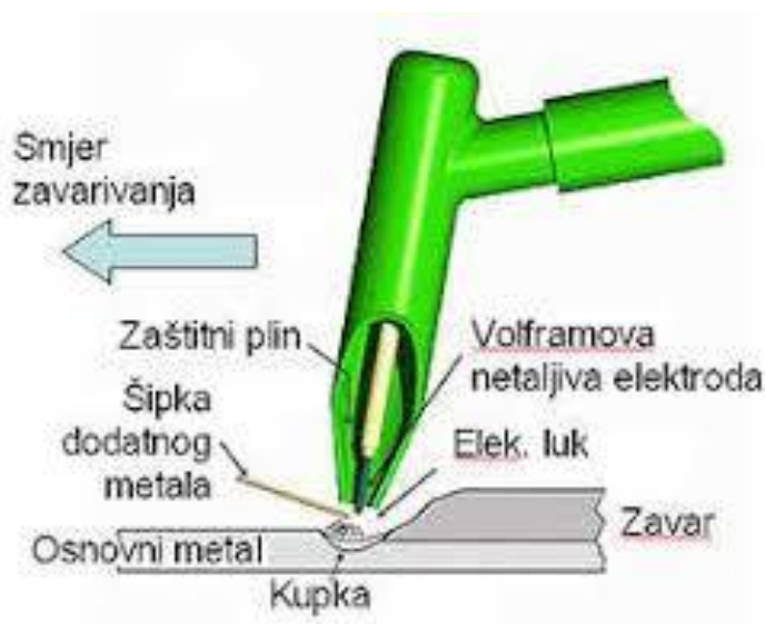
Slika 8. Shema TIG zavarivanja [21]
