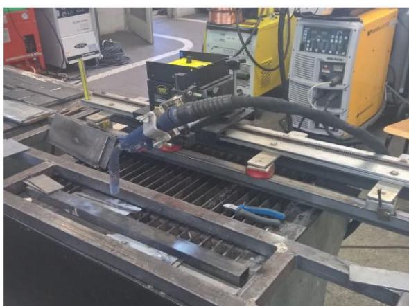
Slika 18. Automatizirano vođenje pištolja
