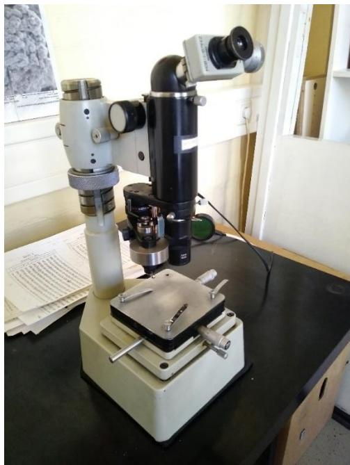
**Slika 29. Uredaj za ispitivanje tvrdoće**
