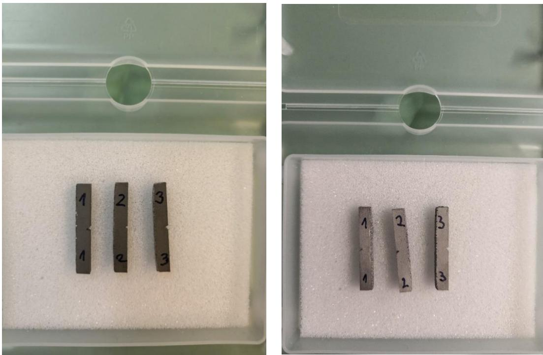
Slika 42. Isprintane epruvete za ispitivanje udarnog rada loma:
