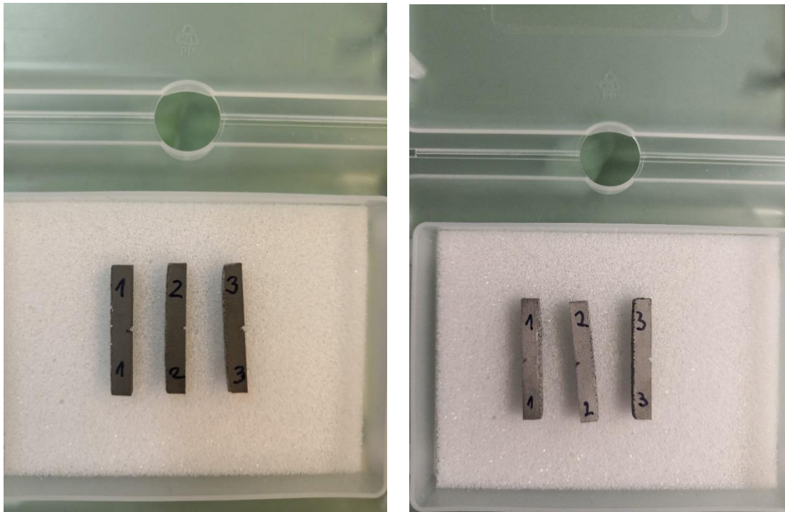
Slika 42. Isprintane epruvete za ispitivanje udarnog rada loma:
