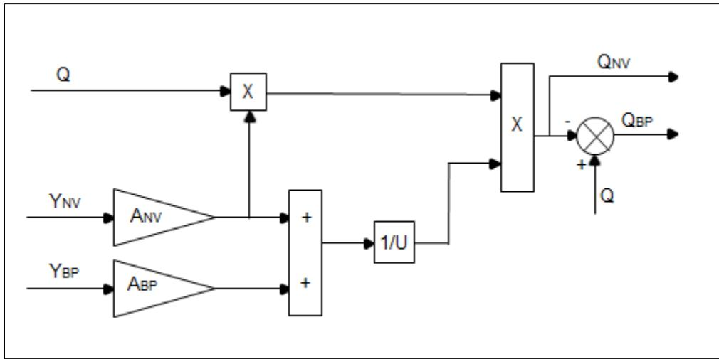
Slika 3.2 Blok shema za protoke  $Q_{NV}$  i  $Q_{BP}$
