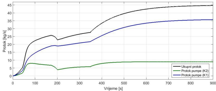
Slika 4.13 Prikaz odziva protoka za pojedinu pumpu - primjer 3
