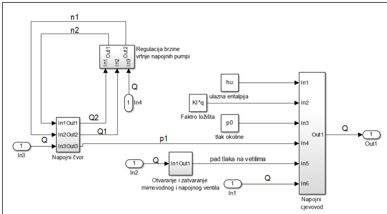
Slika 4.1 Simulacijska shema sustava napajanja u *SIMULINK-u*
