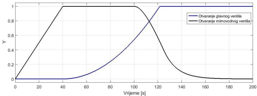
Slika 4.2 Prikaz otvaranja mimovodnog i glavnog ventila
