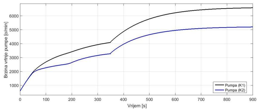
Slika 4.14 Prikaz odziva brzine vrtnje pojedine pumpe - primjer 3
