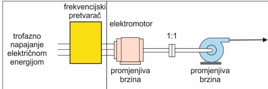
**Slika 2.9 Prikaz položaja ugradnje frekvencijskog pretvarača**
