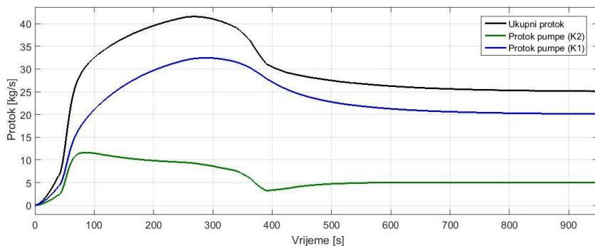
Slika 4.18 Prikaz odziva protoka za pojedinu pumpu - primjer 4
