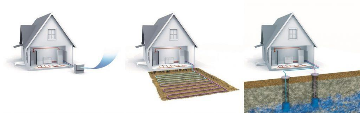
Slika 1.6 Izvori energije za dizalice topline
