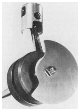
Slika 1.7. Rotirajući zasun na koljenastom vratilu [1]
