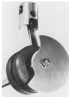
Slika 1.7. Rotirajući zasun na koljenastom vratilu [1]
