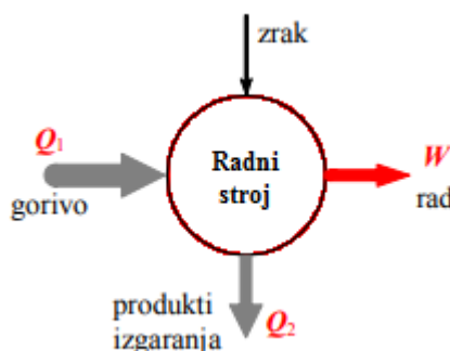
Slika 1.2 Toplinski stroj s unutarnjim izgaranjem [1]
