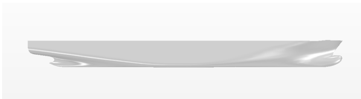
Slika 6. Model broda u programskom paketu STAR-CCM+
