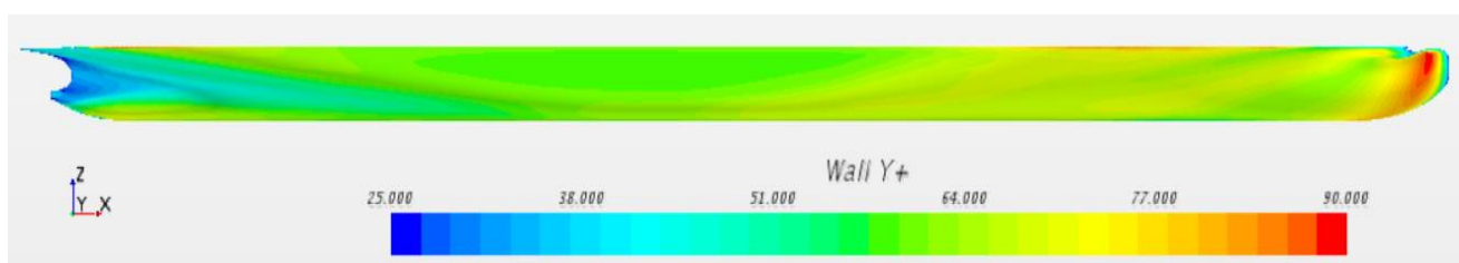
Slika 19. Raspodjela parametra y^+ duž duljine broda
