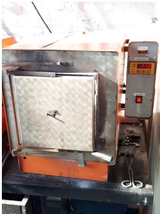
Slika 15. Peć u kojoj se vršilo boriranje
