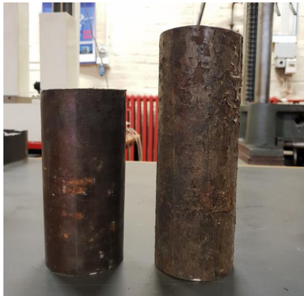
Slika 8. Nova i stara crpna cijev
