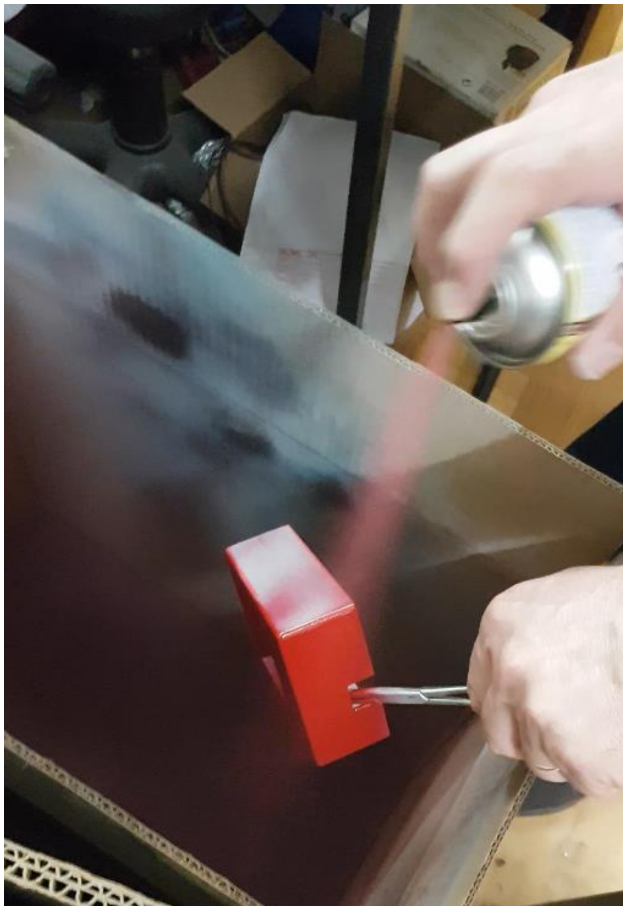
Slika 30. Prikaz postupka lakiranja kućišta QrBox-a
