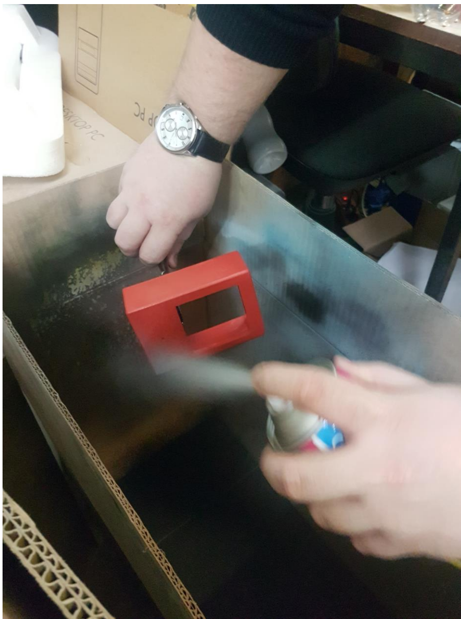
Slika 29. Prikaz postupka obrade akrilnim kitom kućišta QrBox-a
