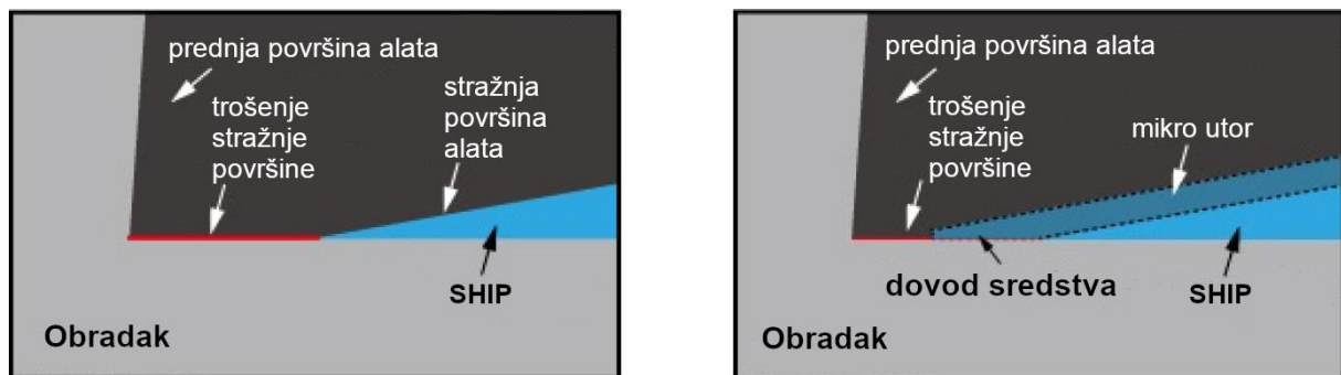
Slika 11 Trošenje prednje i stražnje površine alata od CBN-a ( v_c = 500 m/min, dužina obrade: 400 m) [11]
