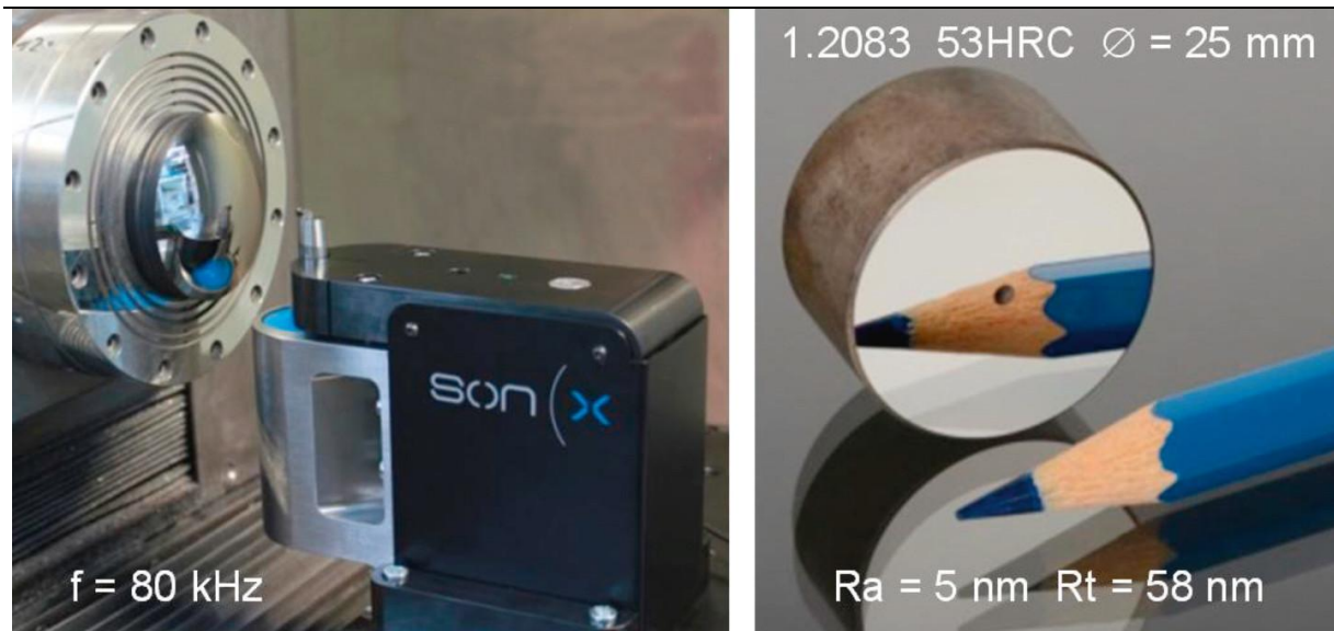
Slika 49 Sustav za tokarenje potpomognuto vibracijom (lijevo), postizive hrapavosti (desno) [8]
