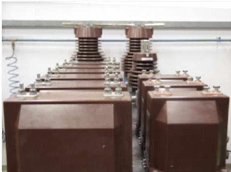
Slika 9. Strujni epoksidni transformator INA[1]
