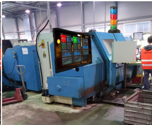
Slika 5.16. Stroj s modernim andon sustavom
