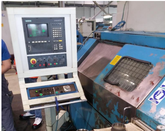
Slika 5.21. Konzola NC stroja
