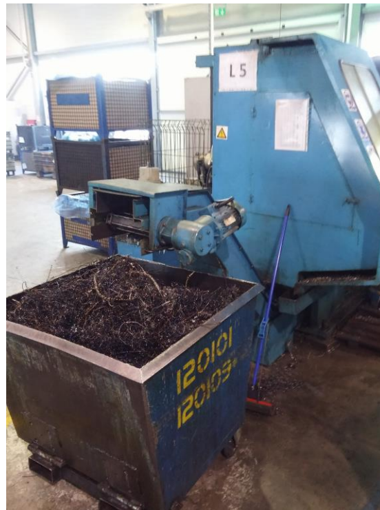
Slika 5.5. Sustav za odvođenje odvojenih čestica iz stroja
