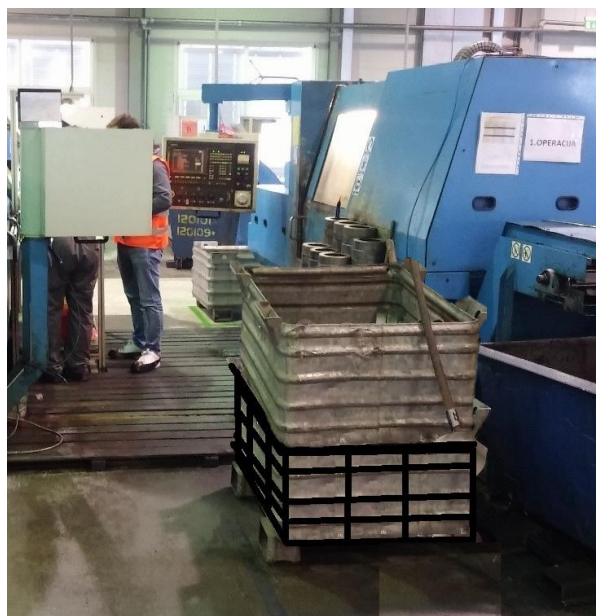
Slika 5.18. Preporučena visina spremnika za lakše izuzimanje otkivka
