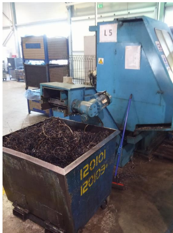
Slika 5.5. Sustav za odvođenje odvojenih čestica iz stroja
