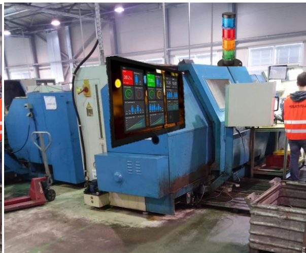
Slika 5.16. Stroj s modernim andon sustavom
