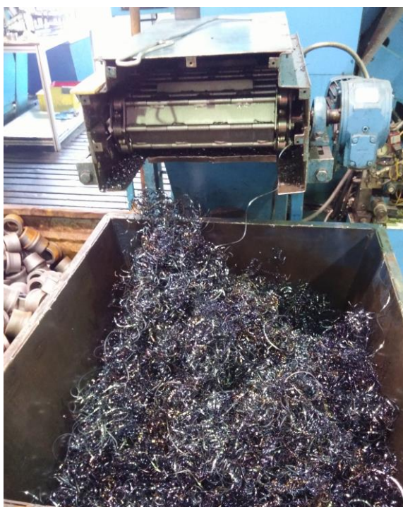
Slika 5.14. Ulazak odvojene čestice ispod konvejera
