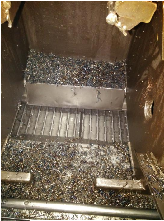
Slika 5.5. Sustav za odvođenje odvojenih čestica iz stroja
