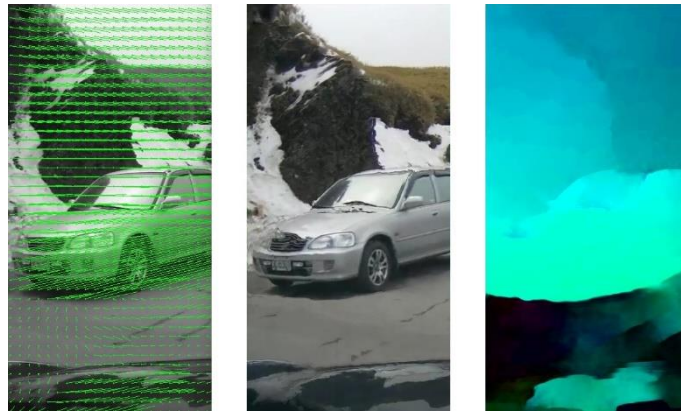
Slika 16. Slika s vektorima brzina prikazim pomoću linija, originalna slika i slika s vektorima brzina prikazanim u HSV sustavu boja
