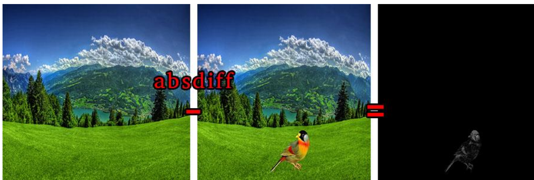
Slika 15. Princip djelovanja apsolutne razlike slika
