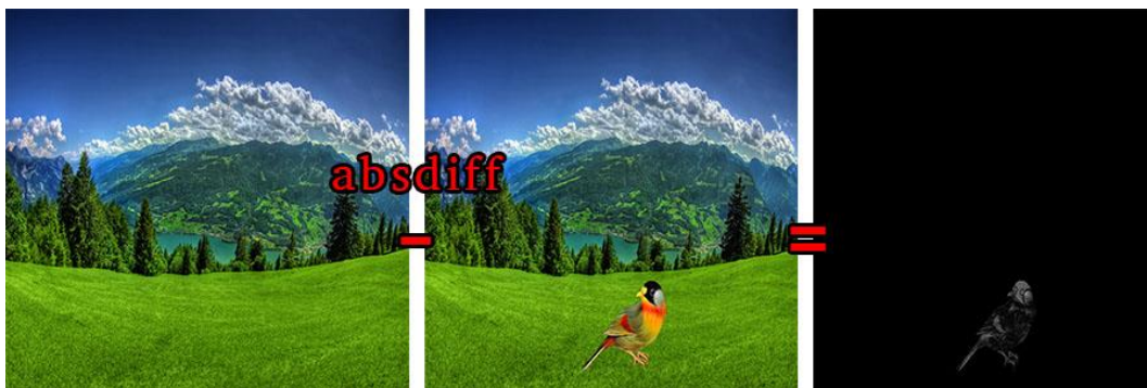
Slika 15. Princip djelovanja apsolutne razlike slika
