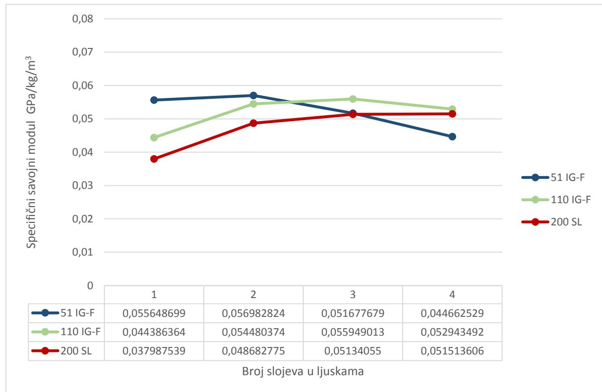
**Slika 53. Specifični savojni modul uzorka**
