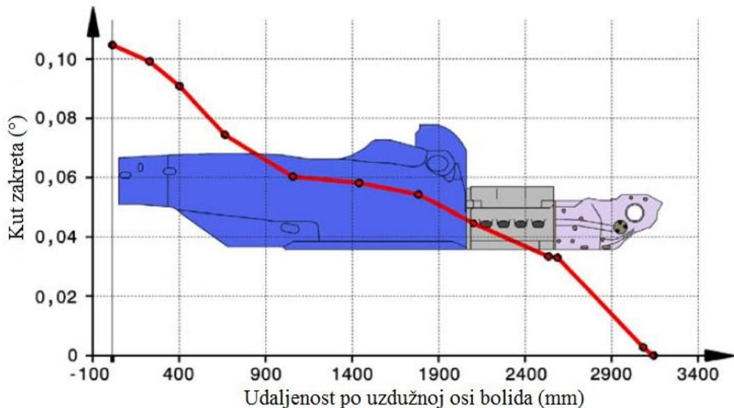
**Slika 20. Kut zakreta šasije prilikom uzdužnog torzijskog opterećenja [14]**
