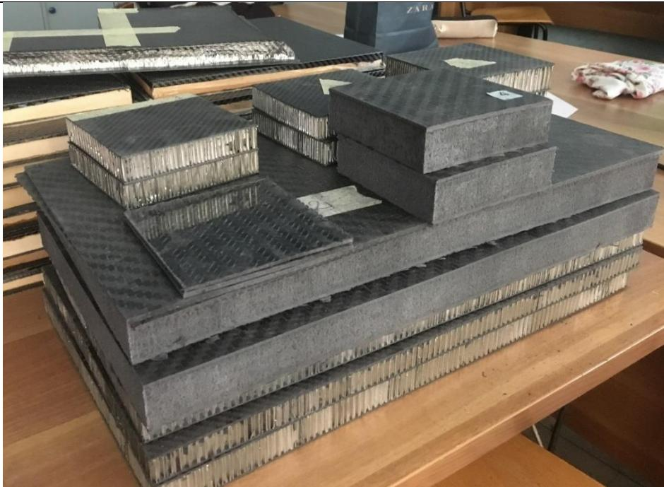
Slika 35. Uzorci za ispitivanje prema zahtjevima FS pravilnika
