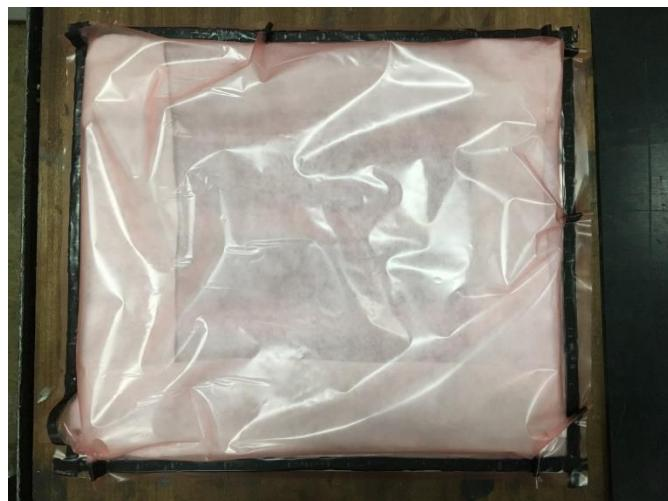
**Slika 29. Uzorci spremni za postupak pečenja**
