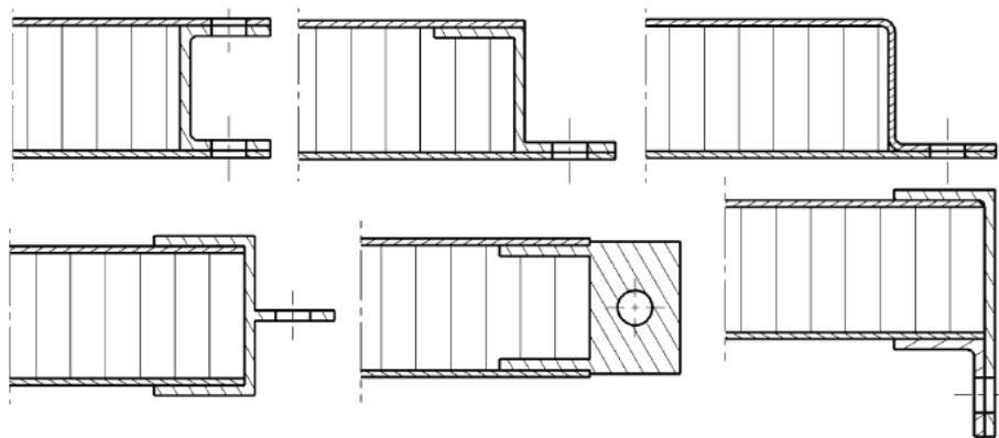
**Slika 15. Varijante završetaka sendvič konstrukcija za prihvat opterećenja [14]**
