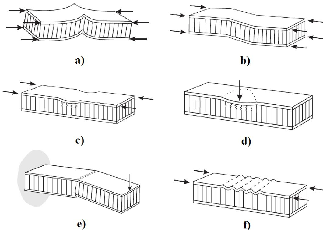
Slika 13. Tipični načini pucanja sendvič konstrukcija [1]
