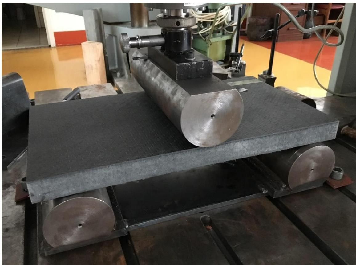
**Slika 39. Postav za ispitivanje ploča prema FS pravilniku**
