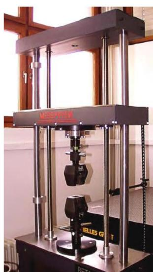
**Slika 36. Statička kidalica Messphysik Beta 50-5**
