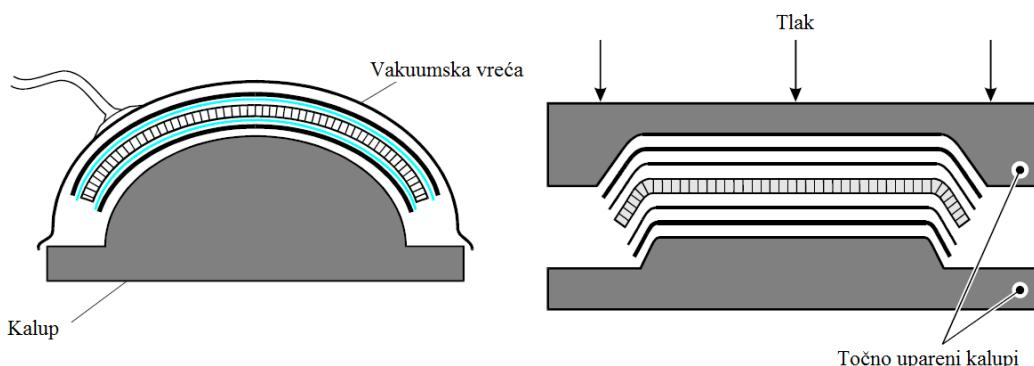
Slika 8. Tipični načini proizvodnje sendvič konstrukcija [1]
