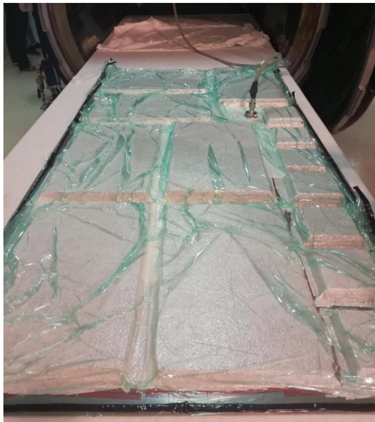
Slika 34. Ispitne ploče prije stavljanja u autoklav
