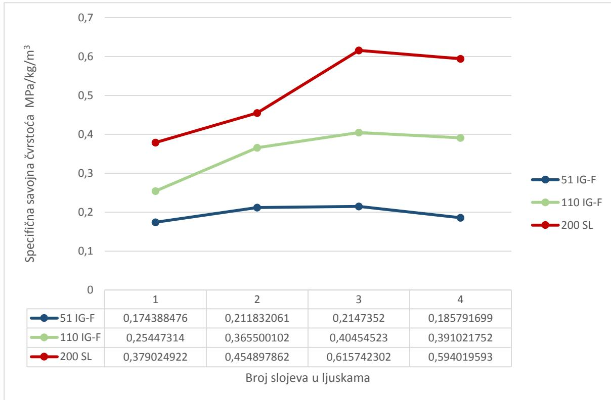
**Slika 54. Specifična savojna čvrstoća uzorka**
