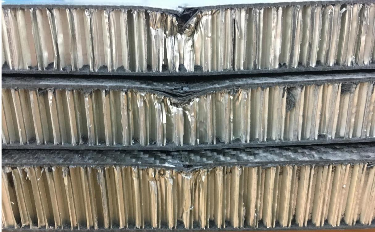
Slika 56. Ispitne ploče postava 1 do 3 nakon provedenog ispitivanja
