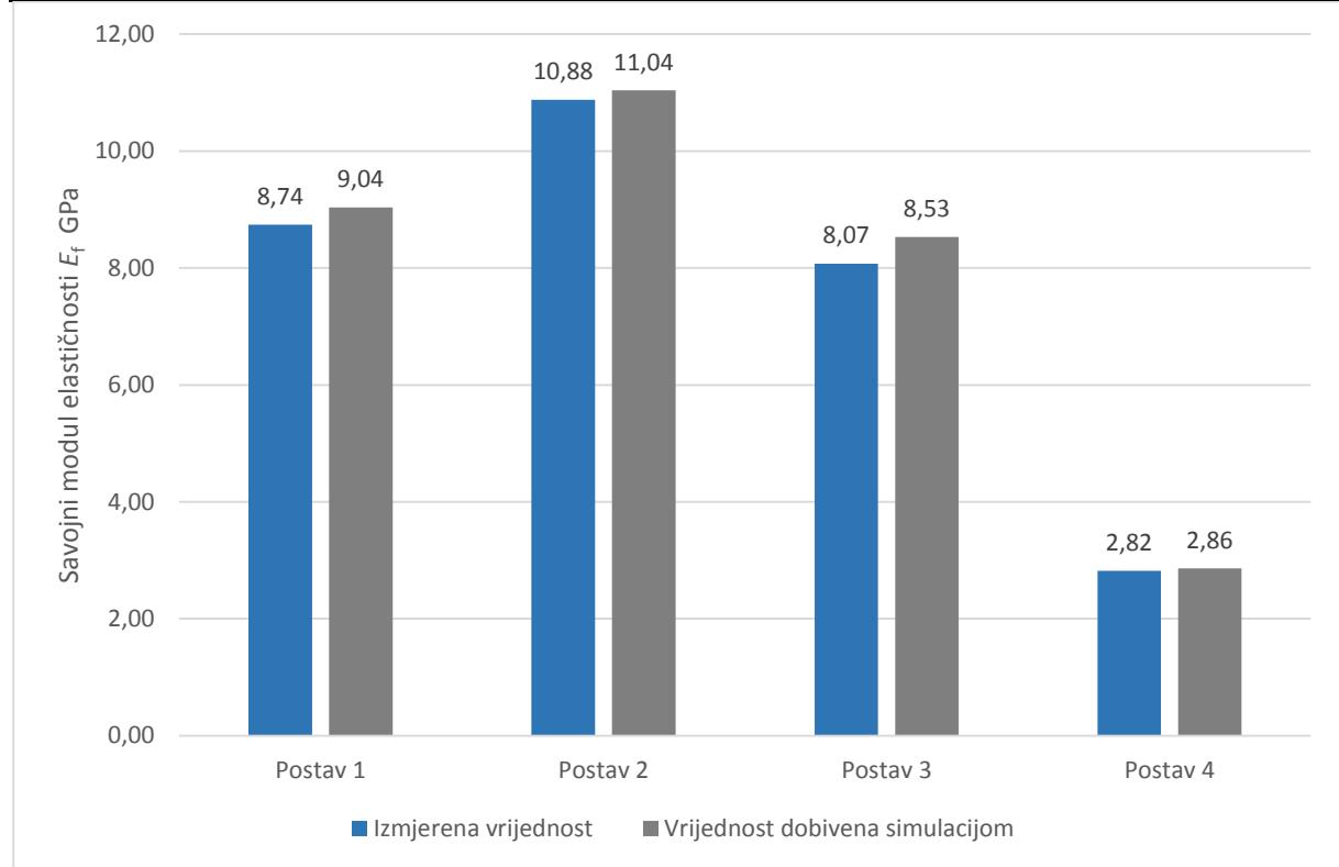
**Slika 65. Usporedba savojnog modula elastičnosti ispitnih ploča s rezultatima simulacije**
