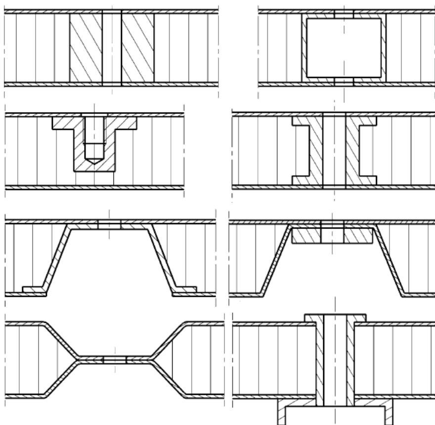
Slika 14. Varijante umetaka za sendvič konstrukcije [14]
