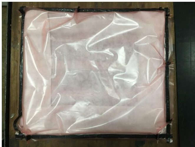
Slika 29. Uzorci spremni za postupak pečenja
