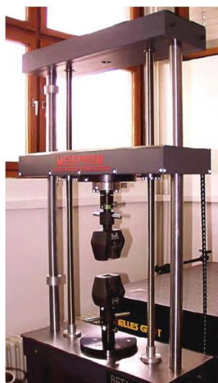
Slika 36. Statička kidalica Messphysik Beta 50-5
