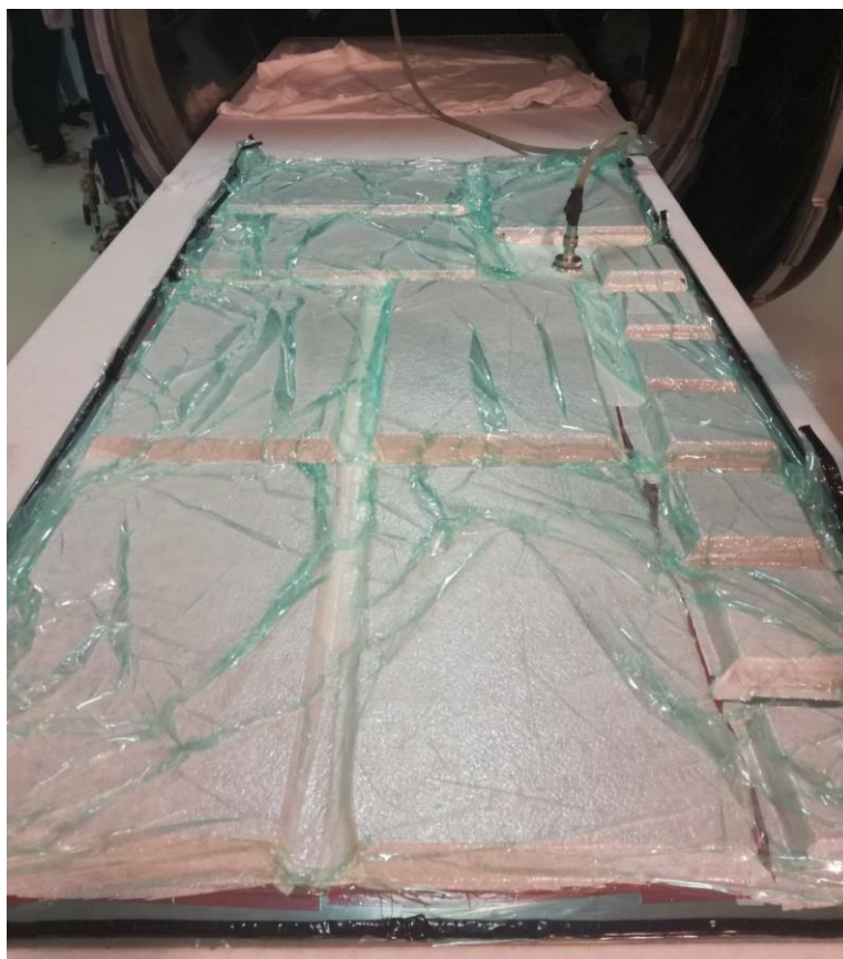
Slika 34. Ispitne ploče prije stavljanja u autoklav
