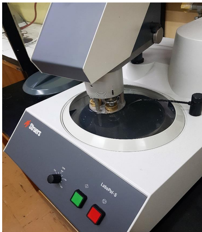
Slika 5.3. Poliranje kompozitnih pripravaka.
