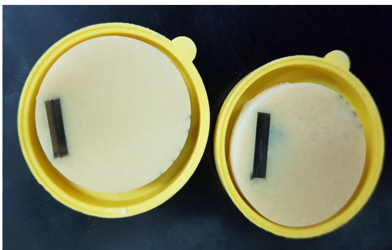
Slika 5.2. Pripremi zaliveni u kalupu u polimernoj masi.
